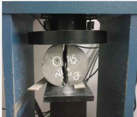
Ilustración 9. Falla de cilindros (Tracción directa).
