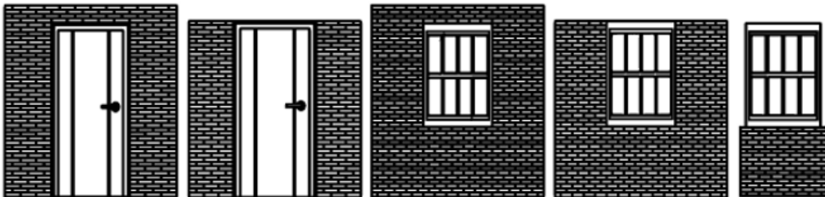
figura 19. Representación de modulación (dinteles y antepechos) del sistema propuesto. Elaboración propia.
