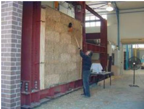
Figura 1 Muro de Balas de Paja
