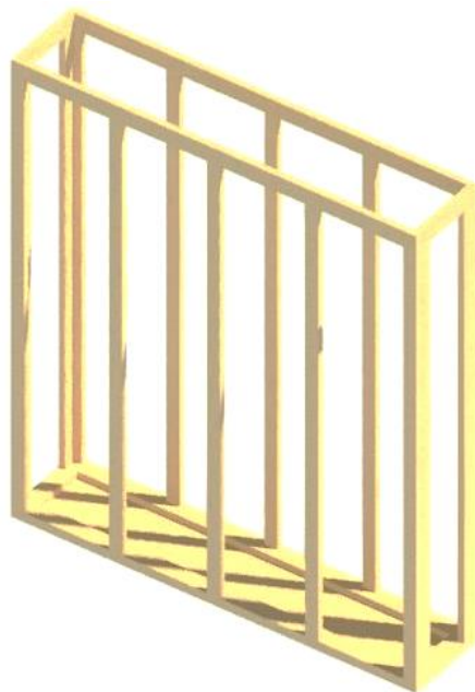
Figura 9 Encofrado de madera para la disposición de la Fibra Vegetal, en la elaboración de muros.
