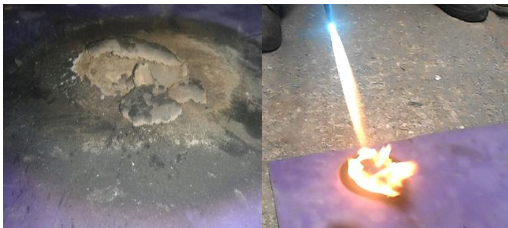
Figura 26. Baldosas actuales sometidas al fuego.
