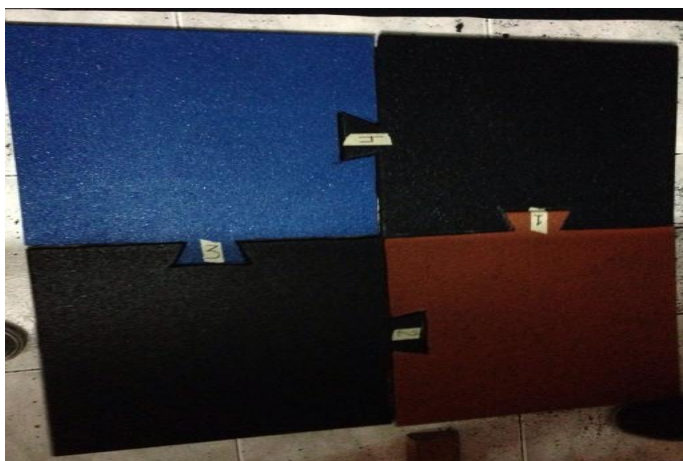
Figura 30. M2 de baldosa de caucho con su respectiva modificación.
