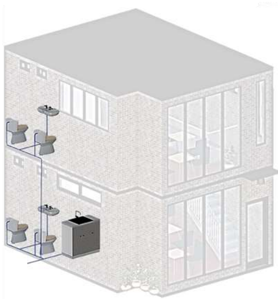
Figura 45. Instalaciones MEP zona A, suministro.
