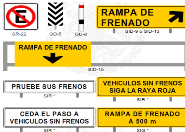
Figura 6. Instalaciones de seguridad de rampas 2
