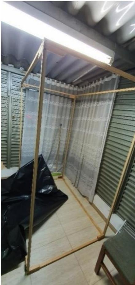
La incubadora está estructurada por palos de madera con dimensiones de 2cm x 2cm, la dimensión de toda la estructura corresponde a una altura de 1.90 m, longitudinalmente de 1.50 m y transversalmente de 1.00 m
