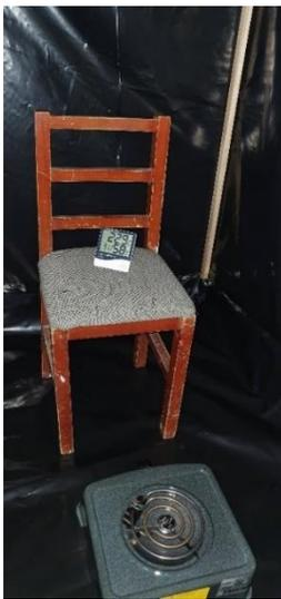
El recubrimiento es esencial y trabajado de manera certera, debido a la importancia que tiene la pérdida de calor y el aislamiento térmico que debe de tener en horas nocturnas, también el aislamiento fue diseñado para prevenir contaminantes no deseados como plagas, insectos y bacterias. El calibre de plástico negro es de 7 y sus dimensiones concuerdan con la estructura, posteriormente se realiza un ingreso con cierre hermético.
