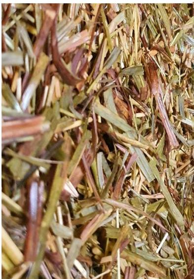
La finalidad en la que se hace estos cortes es para optimizar el crecimiento del micelio, y pueda adherirse de manera correcta donde su esfuerzo sea mínimo, de igual manera se realiza con cada fibra.
