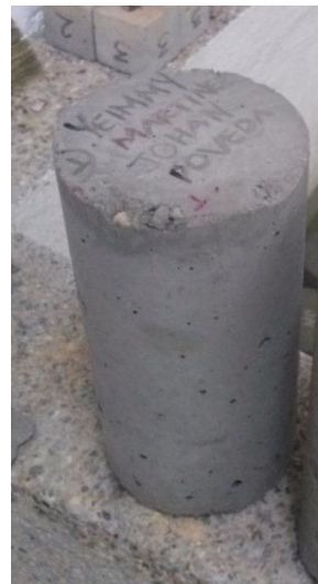
Imagen No. 42: Desencofrado a las 24 h.
