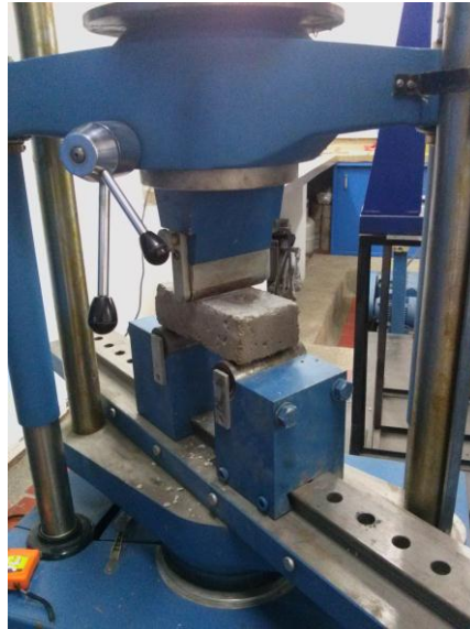
Imagen 51: Prueba a flexotracción
