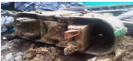
Fig. 4 Daño de dientes en almeja de excavación. [Fuente: Autor]
