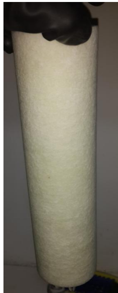
Figura 18. Membranas de microfiltración de celulosa y polipropileno de 5 \mu\text{m} , después de haber sido sometidas al primer tipo de agua.
