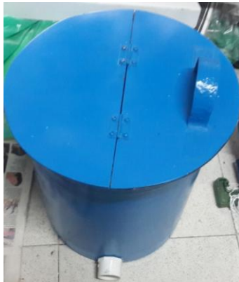
Figura 11. Tanques de almacenamiento de fibra de vidrio.
