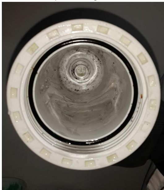
Figura 26. Carcasa de la membrana de carbón activado después de procesar diferentes tipos de aguas residuales.
