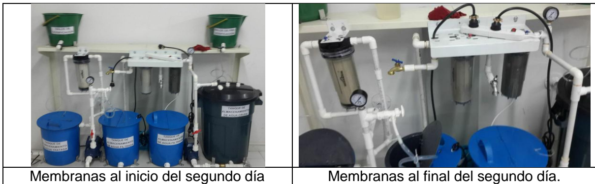
Figura 38. Comparación de las membranas de filtración a la entrada y a salida del segundo día.
