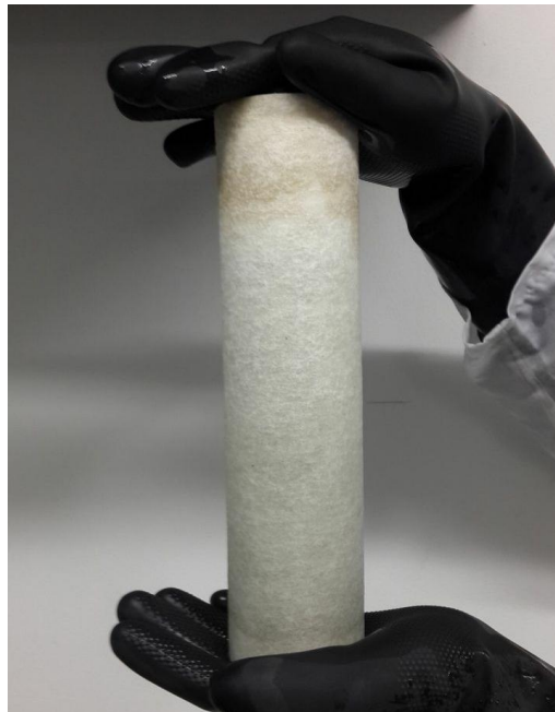
Figura 27. Membrana de celulosa después de 3 pruebas con diferentes tipos de aguas.
