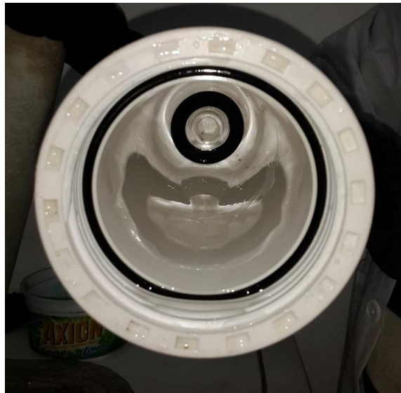
Figura 28. Carcasa de la membrana de celulosa después de procesar diferentes tipos de aguas residuales.
