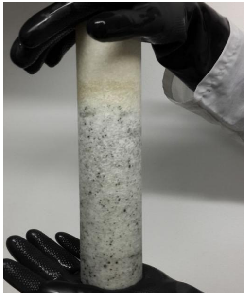
Figura 29. Membrana de polipropileno de 5\mu\text{m} después de 3 pruebas con diferentes tipos de aguas.
