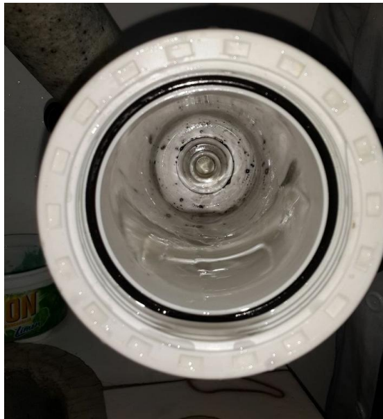
Figura 30. Carcasa de la membrana de polipropileno después de procesar diferentes tipos de aguas residuales.
