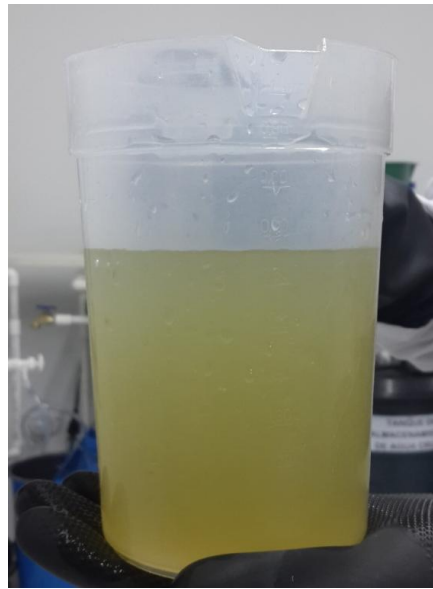
Figura 22. Agua residual a la salida de la planta piloto de membranas de filtración.
