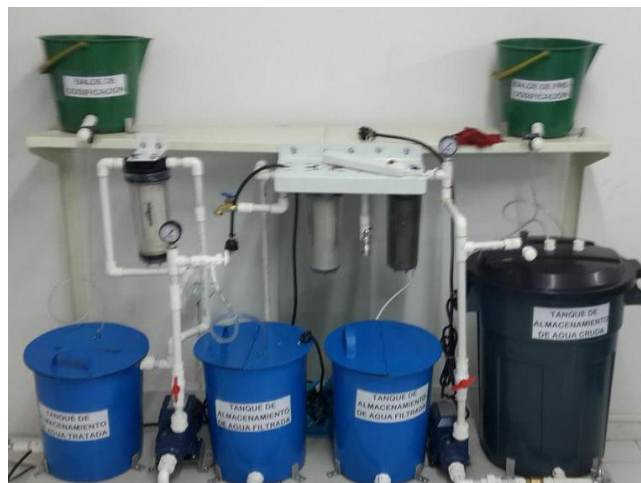
Figura 37. Planta piloto el segundo día de filtración un mismo tipo de agua residual.
