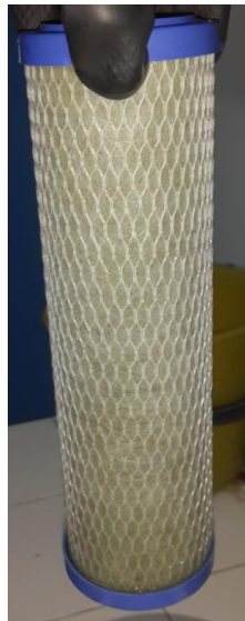
Figura 16. Membrana de carbón activado después procesar las lagunas de oxidación del municipio de Chía.
