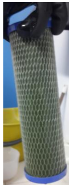
Figura 19. Membrana de carbón activado después procesar las lagunas de oxidación del municipio de Madrid.
