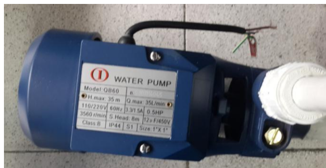
Figura 12. Bombas centrífugas empleadas en el sistema.
