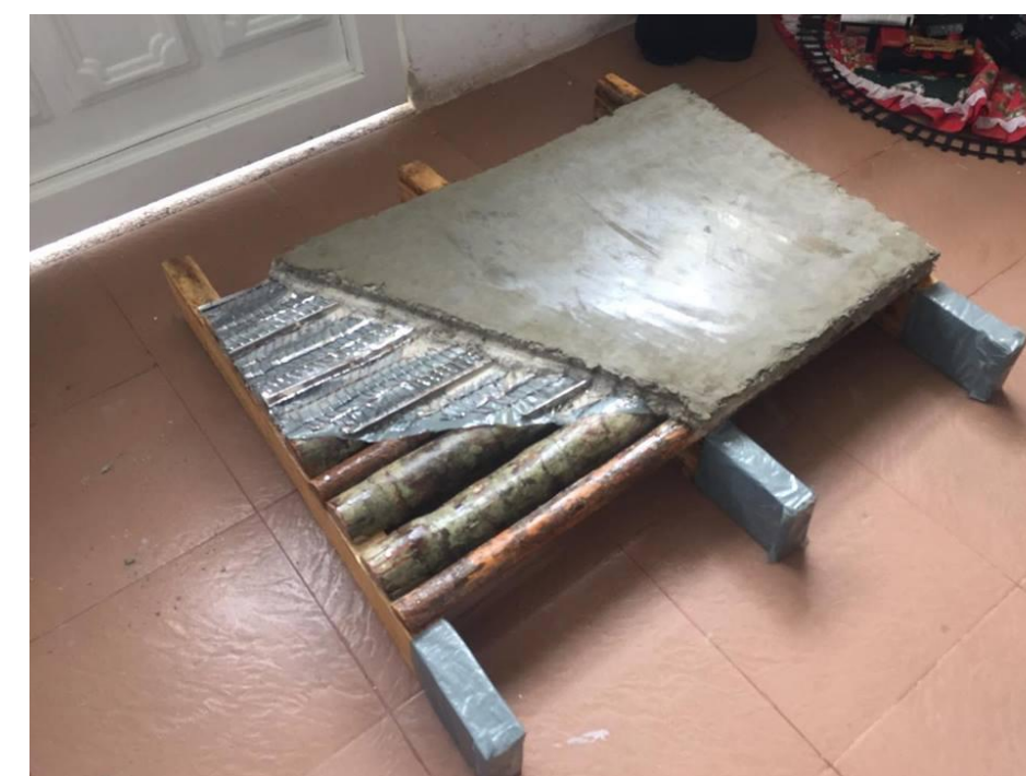
Detalle constructivo entrepiso palma lata. Fuente: propia.
