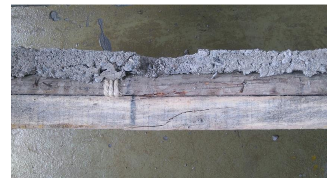
Foto 2. Falla prototipo. Fuente: laboratorio de materiales y procesos Universidad Nacional De Colombia.
