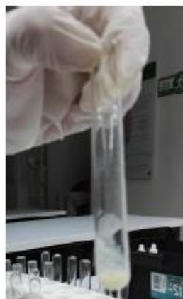
FOTOGRAFIA N°2: Resultado de la muestra aplicando reactivo Tanred. (Positivo para alcaloides).
