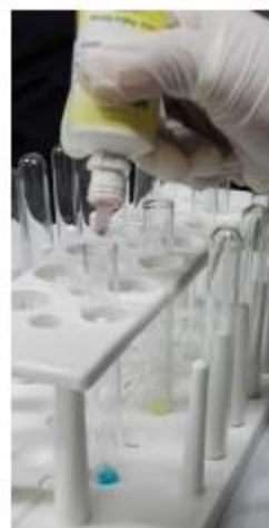
FOTOGRAFIA N°4: Aplicación del reactivo Scott, a la muestra.
