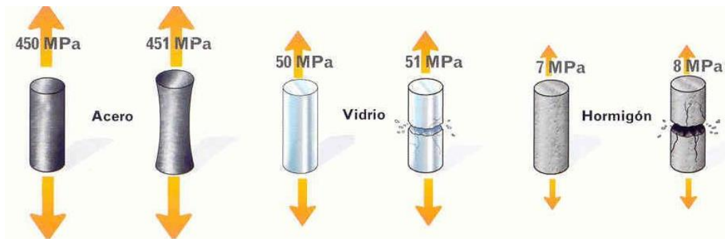
Comportamiento material a esfuerzo
