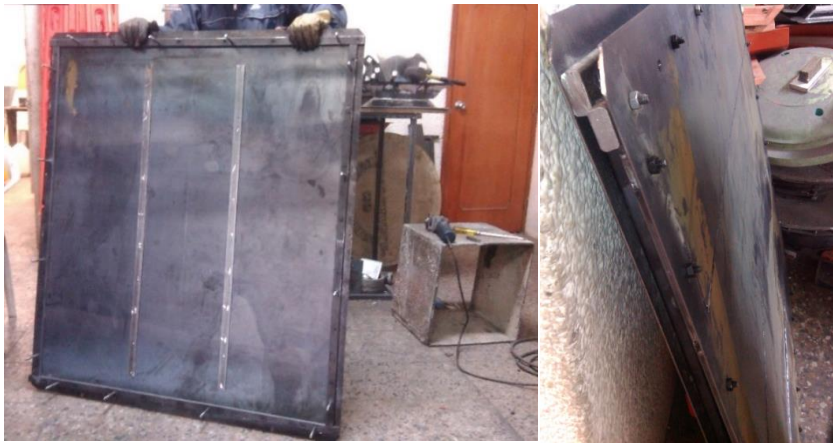
Imagen 6. Molde en Acero para la realización del módulo en polietileno
