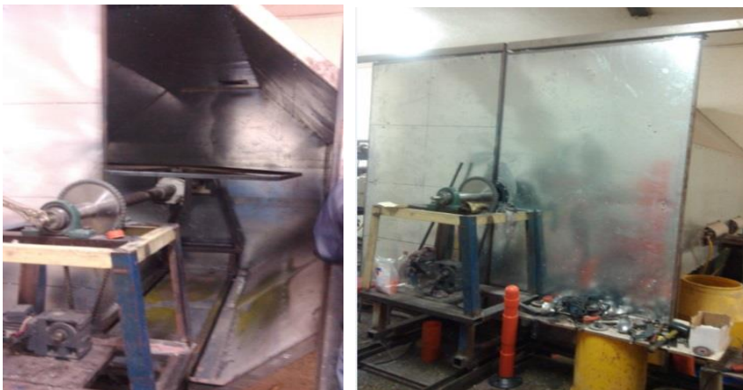
Imagen 7 Horno para fabricación de piezas roto-moldeadas
