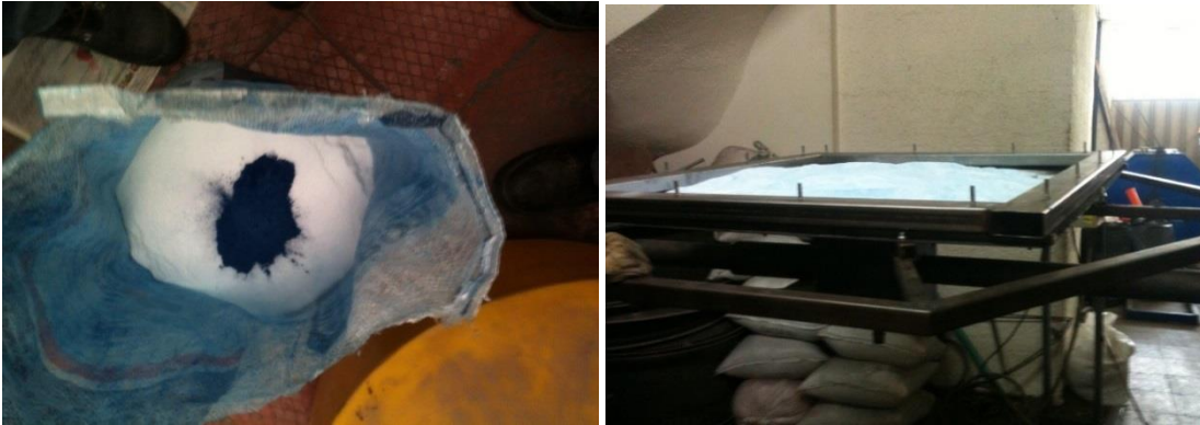
Imagen 12 Polietileno de rotomoldeo con pigmento azul para dar coloración al módulo.
