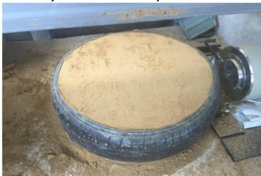
Ilustración 21 Ensayo de corte directo del conjunto llanta con material de lleno.
