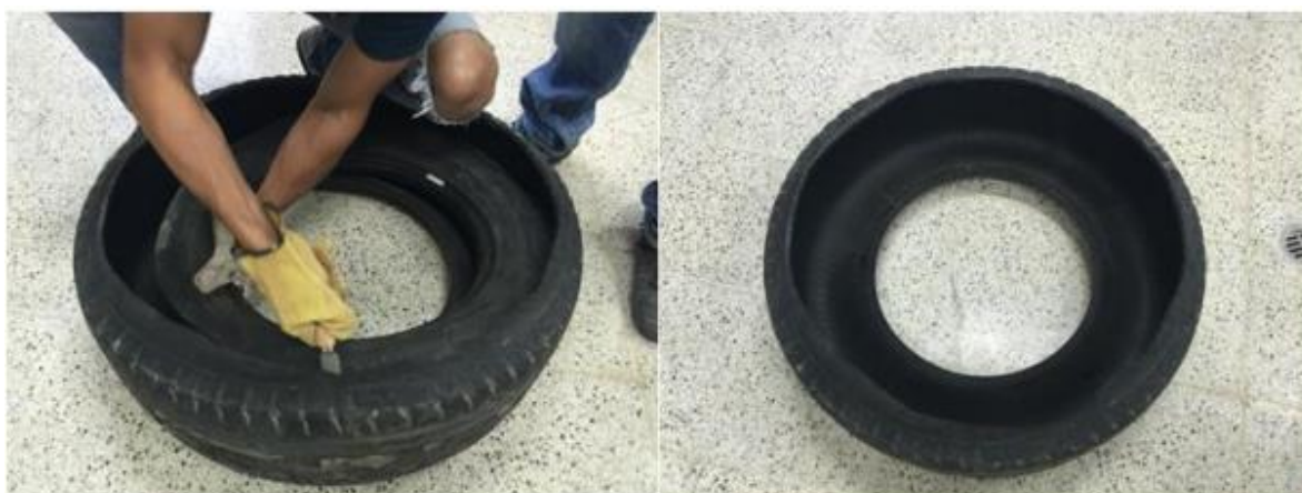
Ilustración 29 Corte de la llanta con cuchillo
