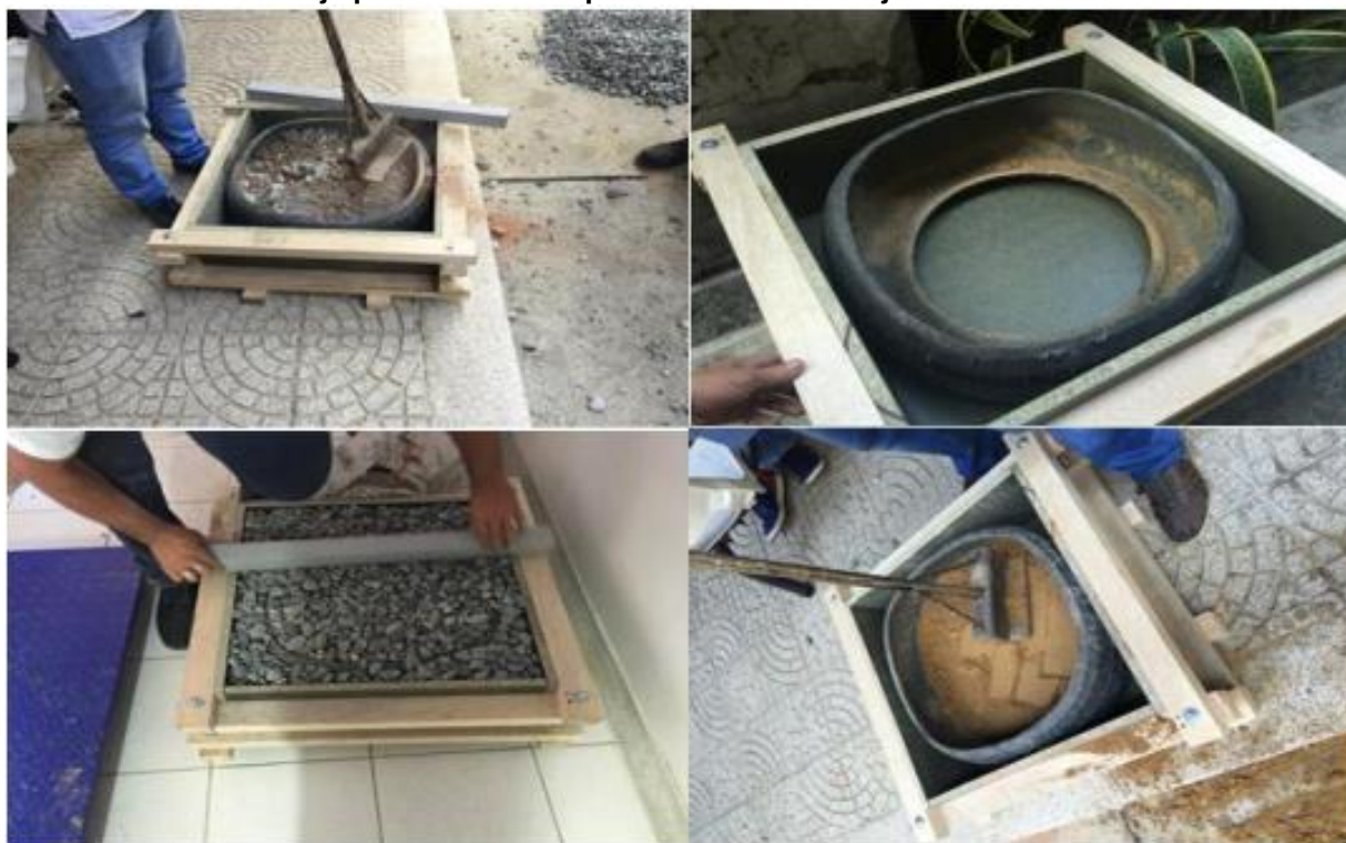
Ilustración 18 Montaje para determinar peso unitario del conjunto llanta de desecho material
