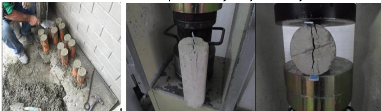
Ilustración 19 Construcción de conectores para cortante y Ensayos uniaxial y de tracción indirecta
