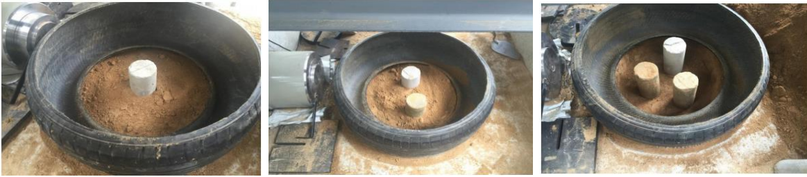
Ilustración 22 Ensayo de corte directo del conjunto llanta con material de lleno adicionando uno , dos y tres conectores a cortante en concreto
