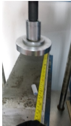
Figura 17. Determinación del punto de carga al centro de la viga
