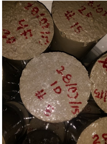
Figura 15. Cilindros marcados con la fecha de elaboración, dosificación y número de referencia.
