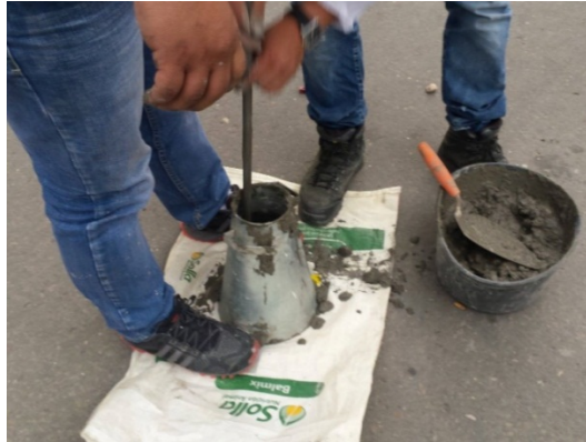
Figura 11. Descargando la varilla según la norma NTC 396.
