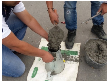
Figura 10. Verificación del asentamiento de diseño
