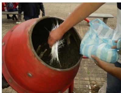
Figura 8. Agregando al diseño de mezcla fibra de vidrio
