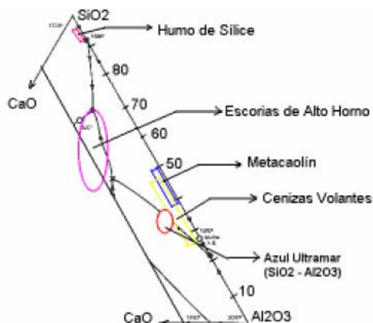
Ilustración 2. Diagrama de fase \text{CaO} - \text{SiO}_2 - \text{Al}_2\text{O}_3 . Localización de materiales puzolánicos
