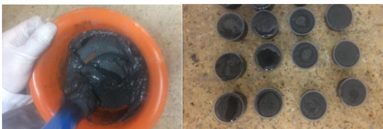
Ilustración 11. a) Mezcla de la pasta de CV y activador y, b) Pastas de CV activadas alcalinamente.
