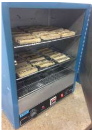
Figura 16. Procedimiento para el secado de las muestras
