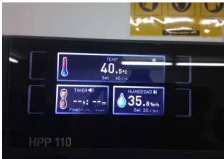
Figura 17. Máquina programada temperatura y humedad para el segundo ensayo
