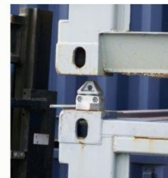
Anclaje Interior Para Unión De Dos Contenedores
