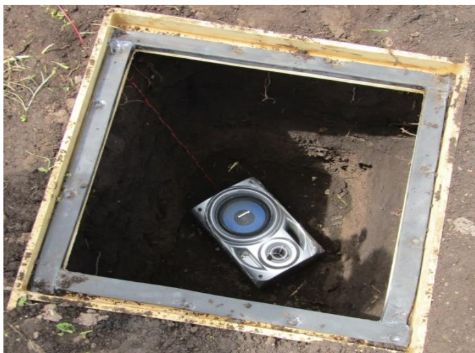
Imagen 20. Excavación y ubicación del baffle emisor de ruido.
