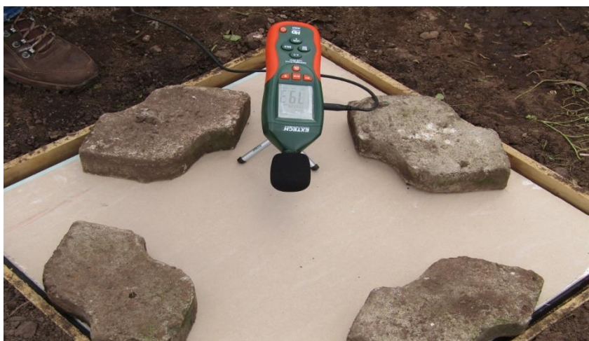
Imagen 10. prueba de aislamiento acústico realizada a lámina de fibrocemento.
