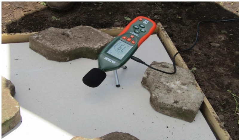
Imagen 9. Prueba de aislamiento acústico realizada a lámina de yeso cartón.
