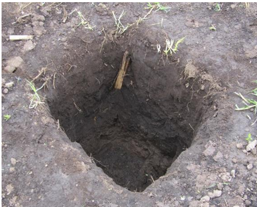
Imagen 18. Cámara de pruebas en terreno de .6x.6x1m.
