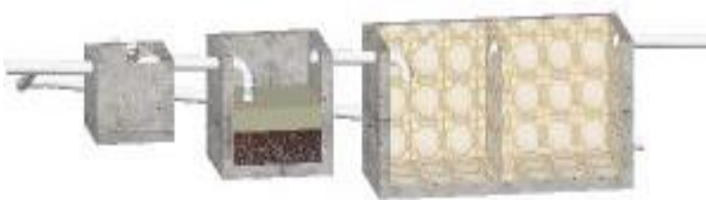
Figura 13. Corte planta de tratamiento aguas grises
