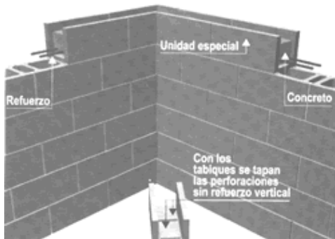
Figura 24. Construcción viga de amarre
