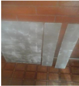
Ilustración 9. Fibra de vidrio después de haberse endurecido. Fuente: Elaboración propia (2016)
