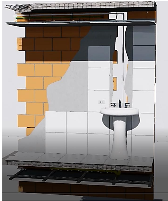
Propuesta de Cumplimiento 1; Tuberías sin regatas, mampostería estructural. Fuente: Propia (2017)
