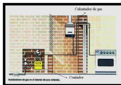
Ilustración 13, Instalación de gas. Fuente: Folguera (1998; p. 74).
