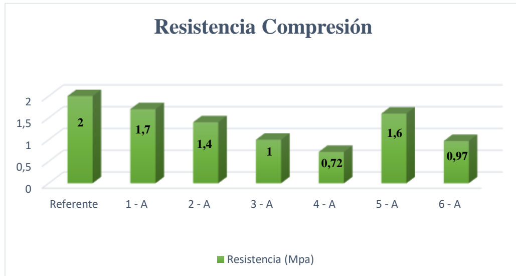
Ilustración 48. Resistencia Compresión. La norma NTC regula bloques entre 2 y 6 MPa
