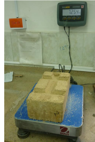
Ilustración 28. Proceso de secado y pesado prueba adsorción
