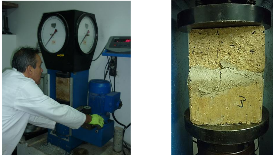
Ilustración 47. Fallo muestras BTC. Compresión
