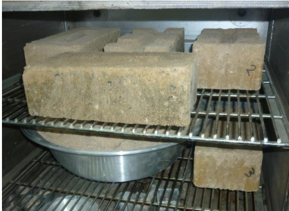
Ilustración 28. Proceso de secado y pesado prueba adsorción
