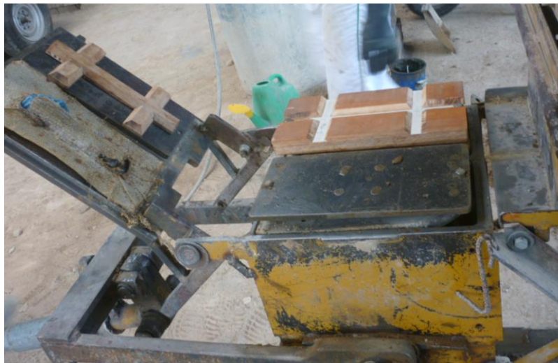
Ilustración 22. Cinva Ram doble (Protierra). Matrices madera. Fuente Propia.
