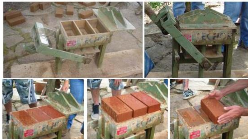
Ilustración 5. Funcionamiento Cimbaram. Fuente Craterre.
