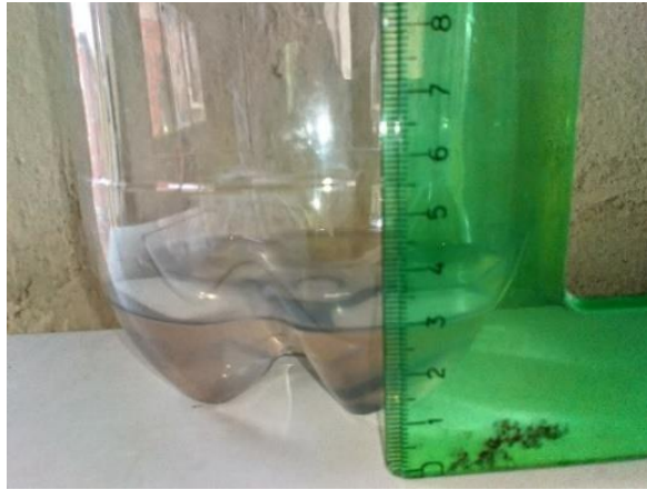
Figura 7. Medición del agua retenida en botella de 3.0 Litros Nota: en esta figura nos da gráficamente la información que se toma con una escuadra y tomada la fotografía desde el teléfono móvil. Elaboración Propia
