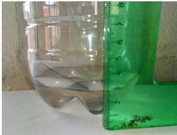
Figura 6. Medición del agua retenida en botella de 2.5 Litros Nota: en esta figura nos da gráficamente la información que se toma con una escuadra y tomada la fotografía desde el teléfono móvil.
