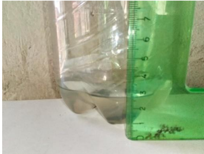
Figura 5. Medición del agua retenida en botella de 2.0 Litros Nota: en esta figura nos da gráficamente la información que se toma con una escuadra y tomada la fotografía desde el teléfono móvil.
