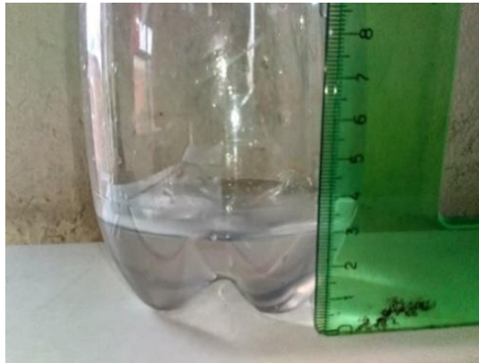
Figura 3. Medición del agua retenida en botella de 1.75 litros Nota: en esta figura nos da gráficamente la información que se toma con una escuadra y tomada la fotografía desde el teléfono móvil. Elaboración Propia
