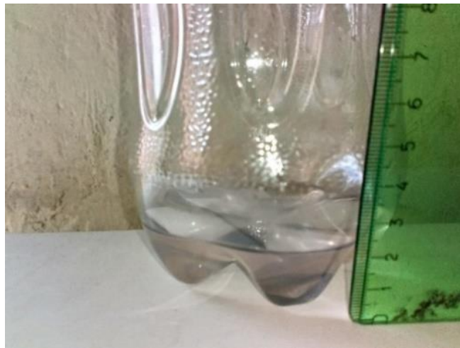
Figura 4. Medición del agua retenida en botella de 1.5 litros Nota: en esta figura nos da gráficamente la información que se toma con una escuadra y tomada la fotografía desde el teléfono móvil. Elaboración Propia
