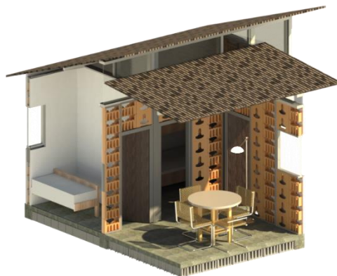
Figura 29 cerramiento en canastas de PET
