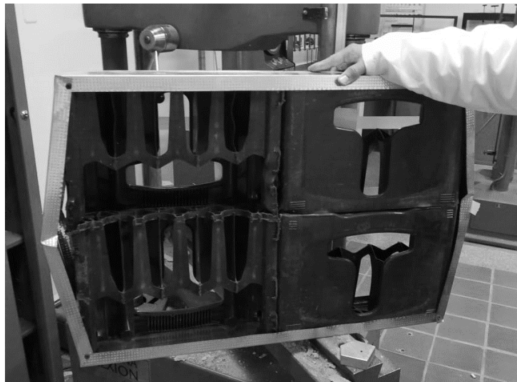
Figura 38 Murete sin pañete y sin canastas
