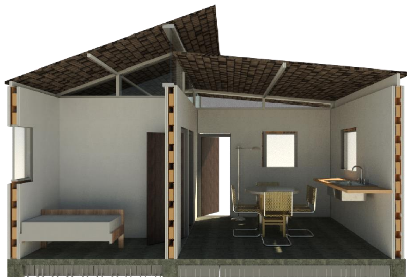
Figura 71 Corte Transversal Fugado
