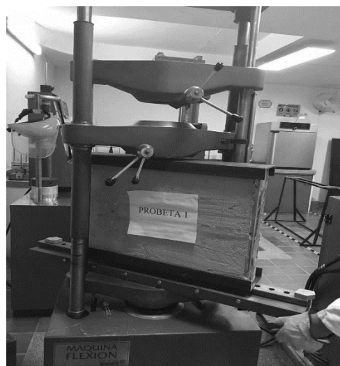
Figura 35 Correcta instalación de muretes sobre maquina
