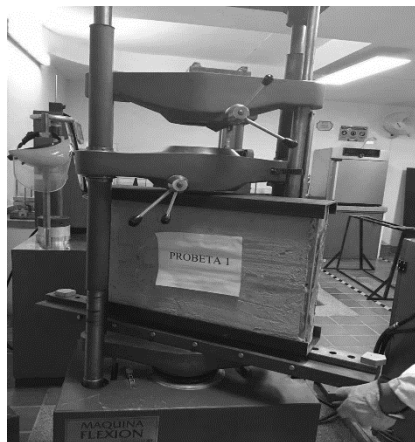
Figura 32 Correcta instalación de muretes sobre maquina
