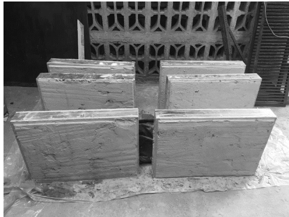
Figura 34 Fabricación de Muretes de ensayos
