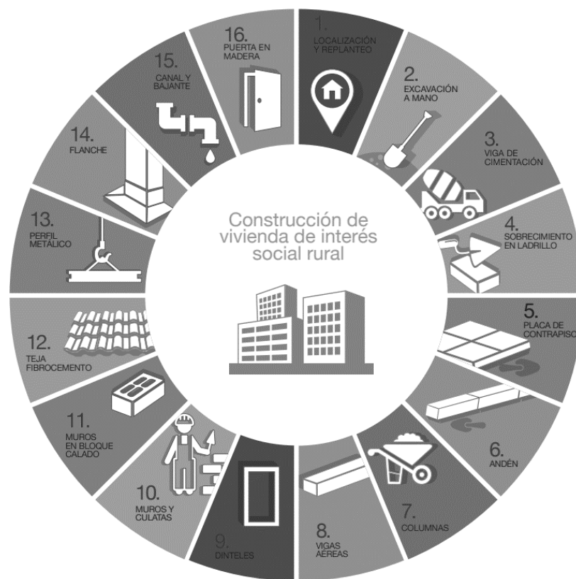
Figura 5 Proceso de Construcción
