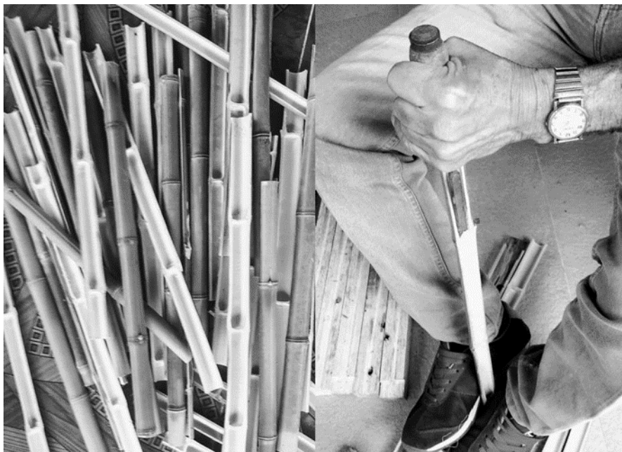
Figura 26. Bambú corta y proceso de eliminar el nudo interior. Elaboración propia.
