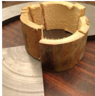
Figura 11. Muestra de corte de guadua con la Prensa hidráulica 100 ton manual. Fuente: Elaboración propia
