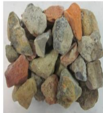
Grava RCD de Mampostería
