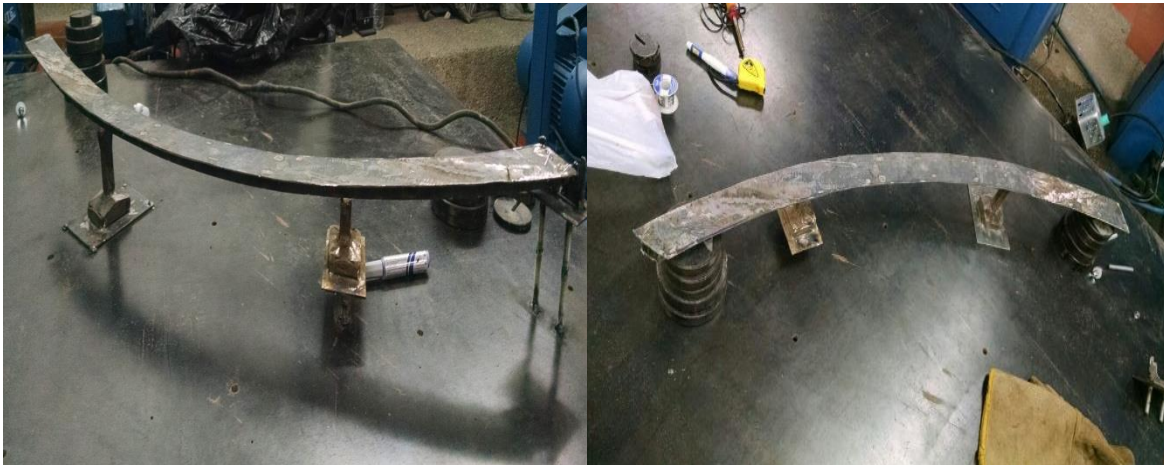
Figura 57 Montaje de elementos estructurales del puente en la mesa vibratoria
