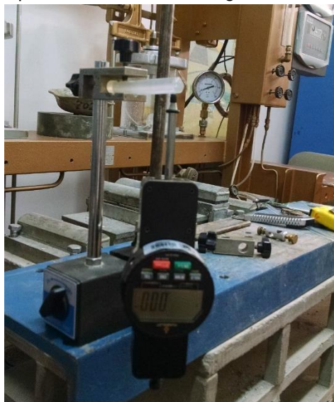
Figura 54 Montaje del sistema para la obtención de la rigidez de una barra de silicona
