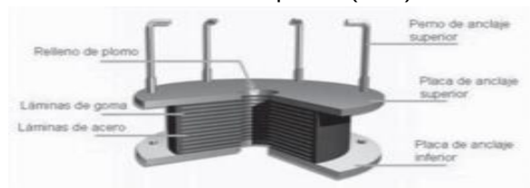
Figura 2. Aisladores elastómericos con núcleo de plomo (LBR).
