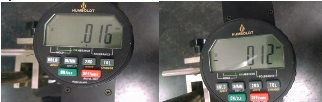
Figura 59 valores de deformación de aisladores.
