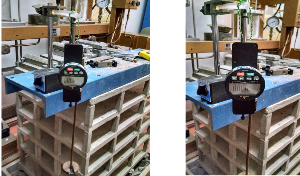
Figura 55. Valores de deformación por carga 233 g con barra de 4 cm .
