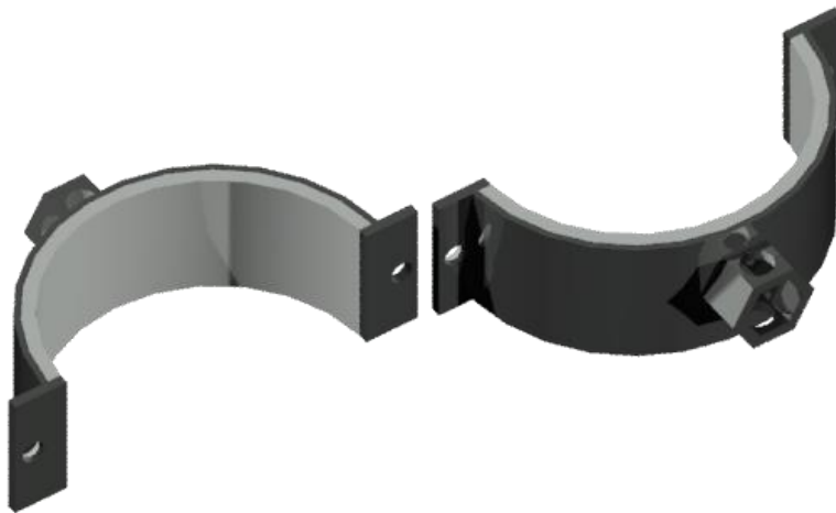
figura 20: Despiece unión planteada. Elaboración propia
