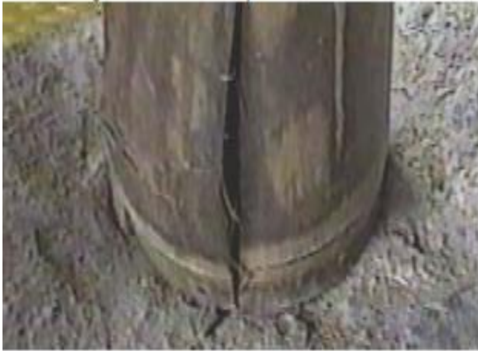
figura 7; Deformación a compresión. Figura original de Clavijo y Trujillo, 2000. Tomado de Takeuch 2004
