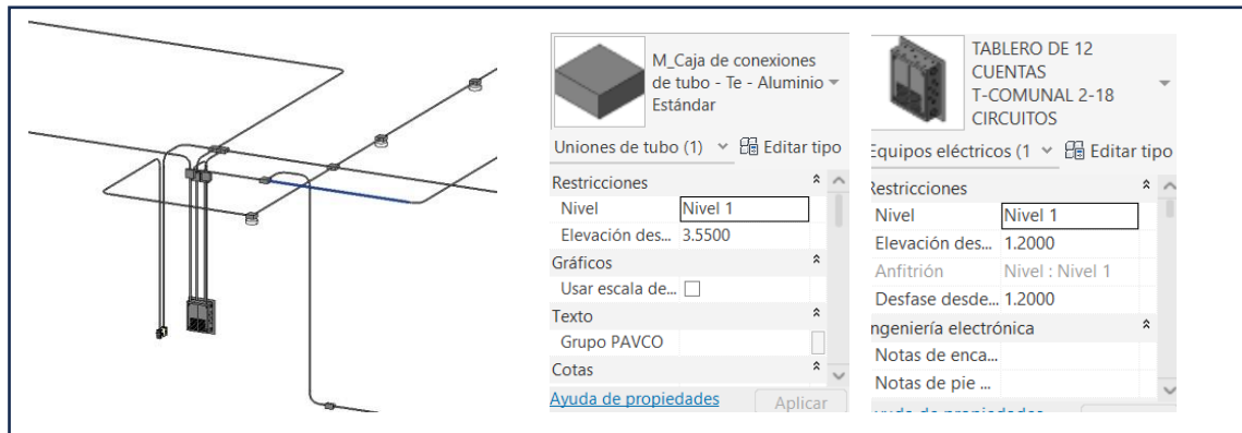
Detalle y especificación de elementos red eléctrica.
