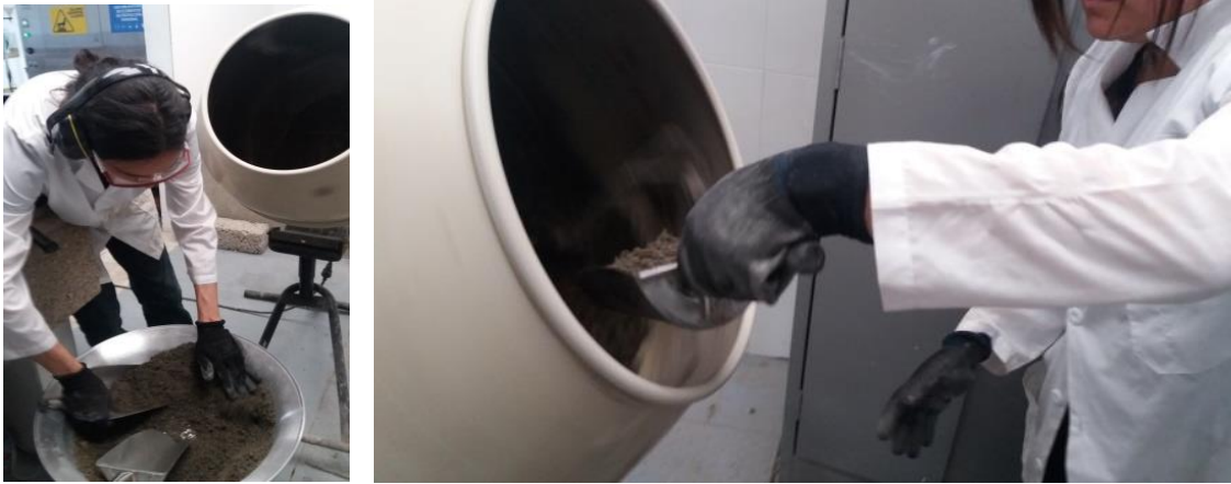
Figura 23: Proceso de mezcla concreto con fibras de vidrio. Fuente: (Autores. 2018)
