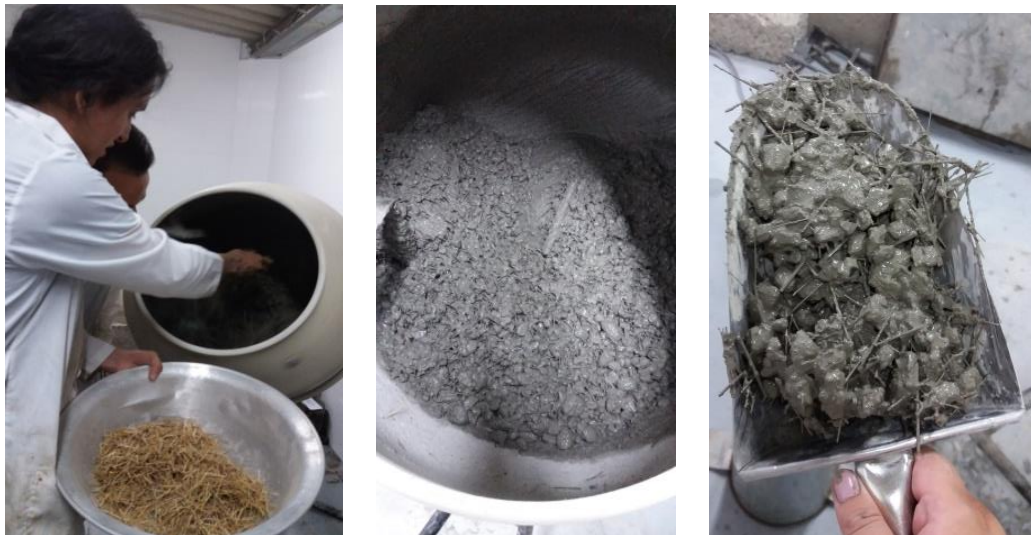
Figura 24: Proceso de mezcla concreto con fibras de guadua. Fuente: (Autores. 2018)
