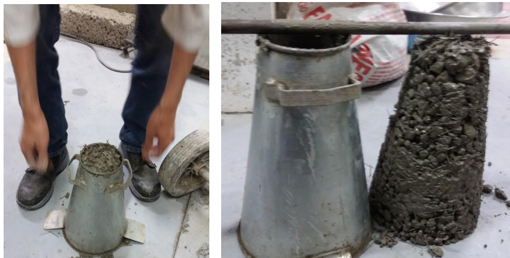
Figura 27: Ensayo de asentamiento concreto con fibras de guadua 1". Fuente: (Autores. 2018)
