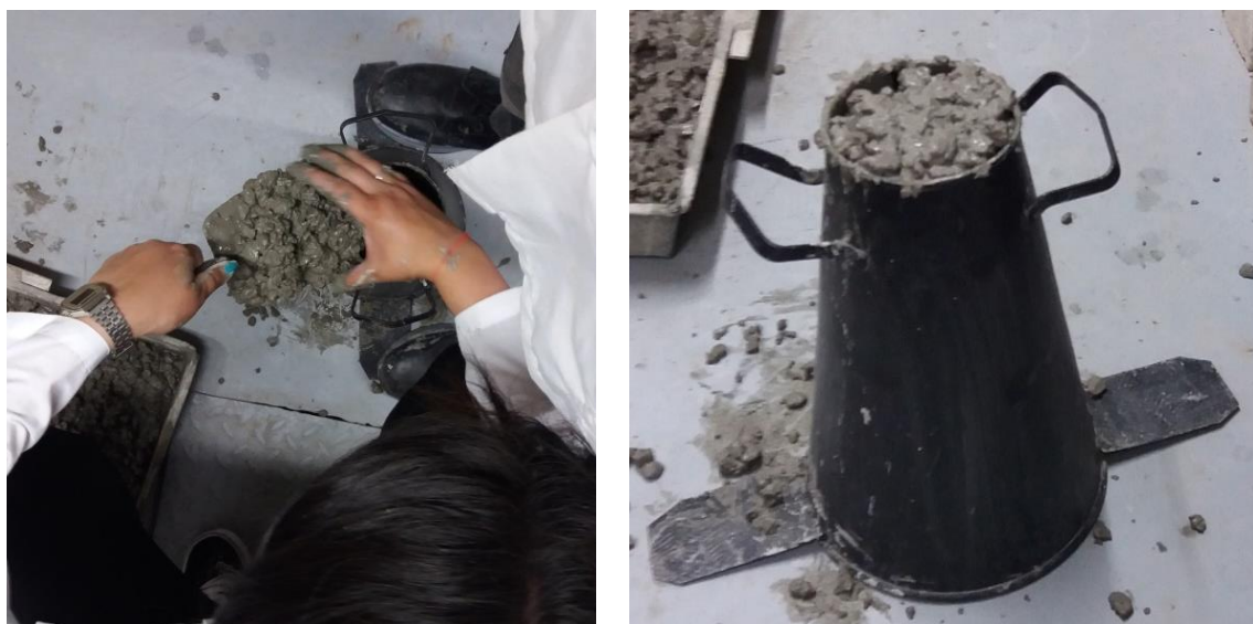
Figura 25: Ensayo de asentamiento concreto simple 1 1/2". Fuente: (Autores. 2018)
