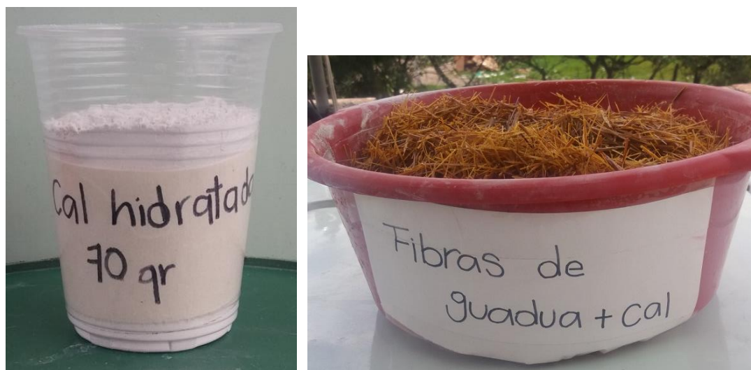
Figura 16: Proceso de inmunización con cal. Fuente: (Autores. 2018)
