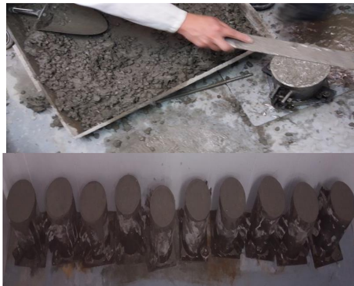
Figura 29: Llenado de moldes concreto con fibras de vidrio. Fuente: (Autor. 2918)
