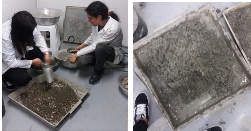
Figura 22: Proceso de mezcla concreto convencional. Fuente: (Autores. 2018)
