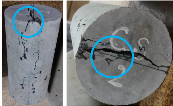
Figura 45: Fisuras de cilindros en concreto convencional. Fuente: (Autores.2108)
