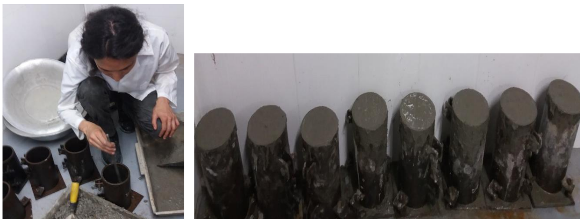
Figura 28: llenado de moldes cilindros concreto simple. Fuente: (Autores . 2018)
