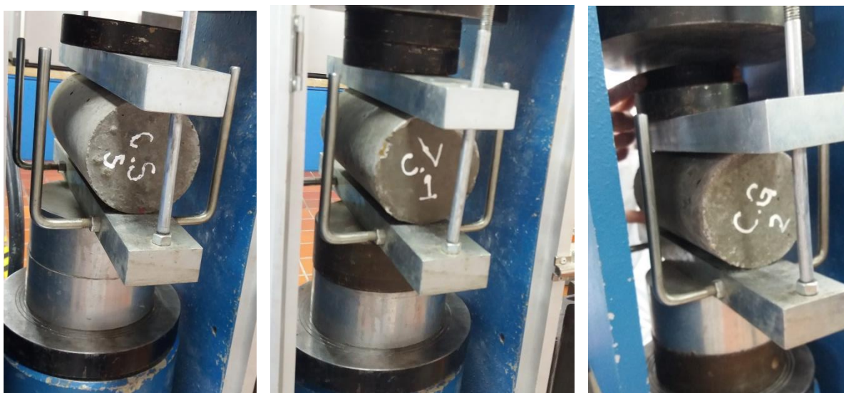
Figura 4: Ensayos a tracción indirecta cilindros en concreto. Fuente: (Autores. 2018)
