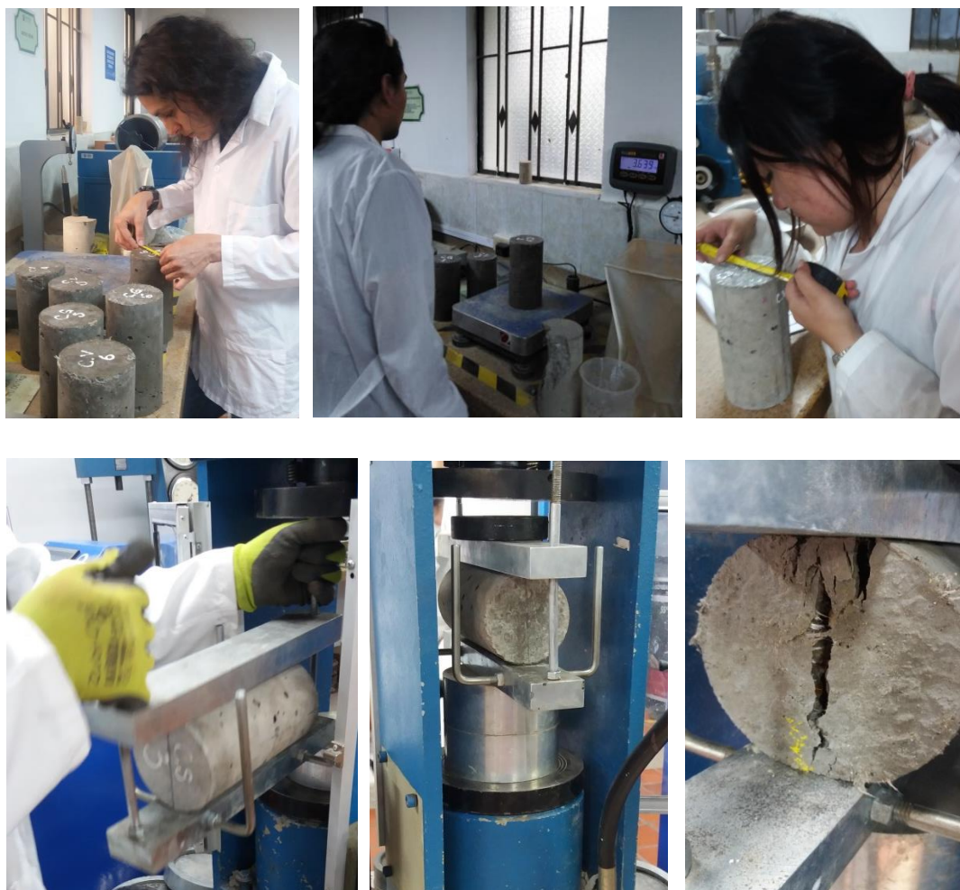
Figura 5: Proceso de ensayo a tracción indirecta.
