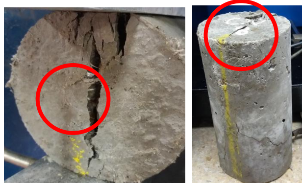
Figura 46: Fisuras concreto con 1% de adición de fibras de vidrio. Fuente: (Autores.2018)
