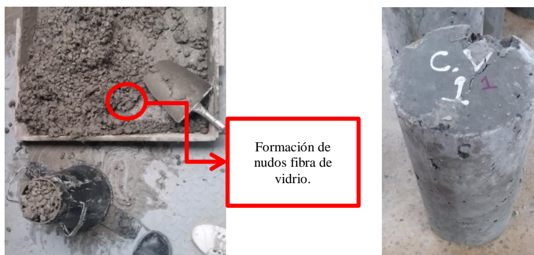
Figura 42: Mezcla concreto con fibras de vidrio. Fuente: (Autores. 2018)
