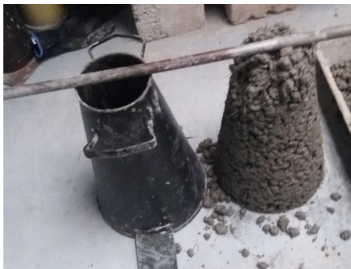
Figura 26: ensayo de asentamiento concreto con fibras de vidrio 1". Fuente: (Autores. 2018)
