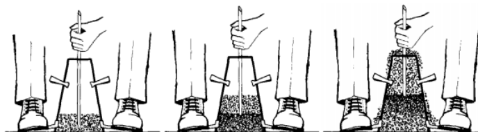
Figura 11: Llenado cono de Abrams Fuente: (Barreros. 2014)
