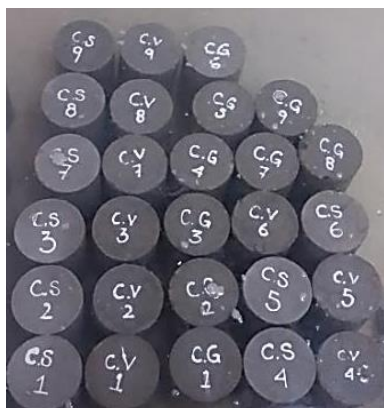
Figura 31: Curado cilindros en concreto.
