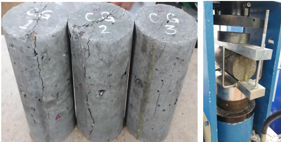
Figura 41: Resultados cilindros concreto con fibras de guadua. Fuente: (Autores, 2018)
