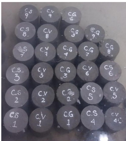
Figura 3: cilindros en concreto elaborados con los tres tipos de mezcla Fuente: (autores. 2018)
