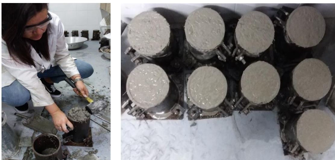
Figura 30: Llenado de moldes concreto con fibras de guadua. Fuente : (Autores. 2018)
