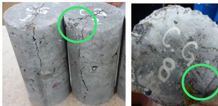
Figura 47: Fisuras concreto con 1% de adición de fibras de guadua. Fuente: (Autores.2018)
