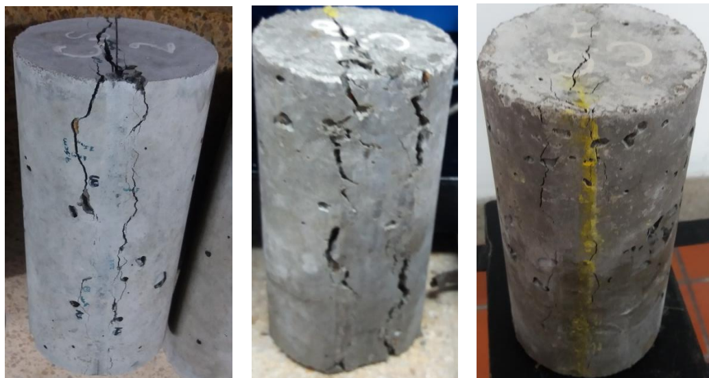
Figura 49: Proceso de fisuración de los cilindros según su diseño de mezcla.
