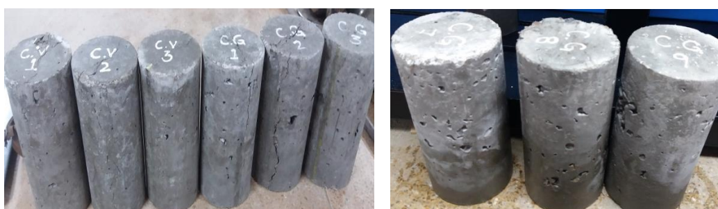
Figura 44: cilindros en concreto con fibras de guadua. Fuente: (Autores. 2018)
