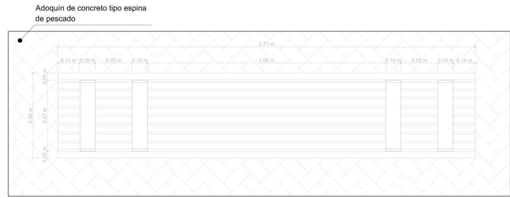
P3 PLANTA BANCA 3 ESCALA 1:10
