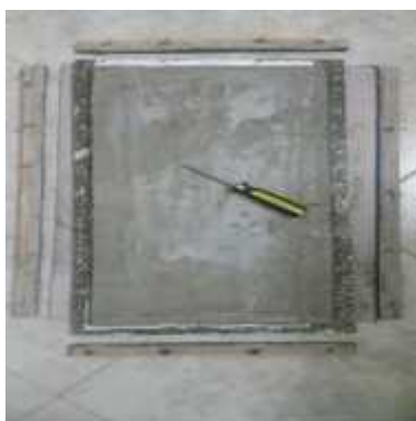
Fotografía 23 Desarmado del molde
