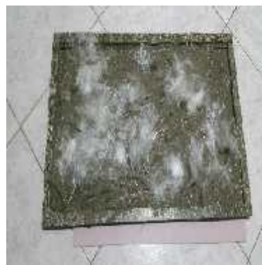
Fotografía 25 Adición de fibra de vidrio al modelo
