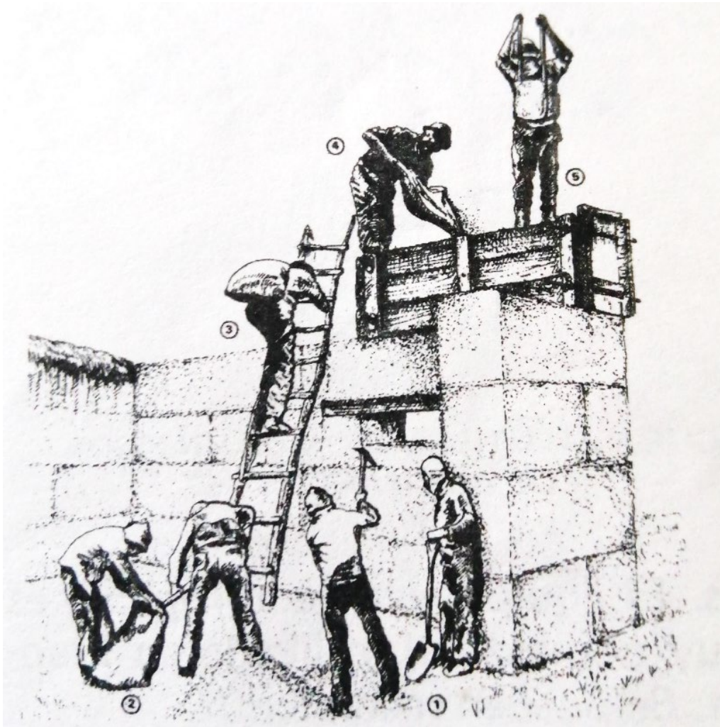
Figura 10. Proceso de construcción de un muro en tapia pisada.
