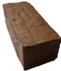
Figura 30. Muestra de tierra para pruebas de resistencia.
