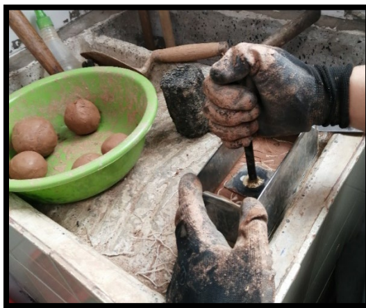
Figura 18. Elaboración de una muestra en tapia pisada.
