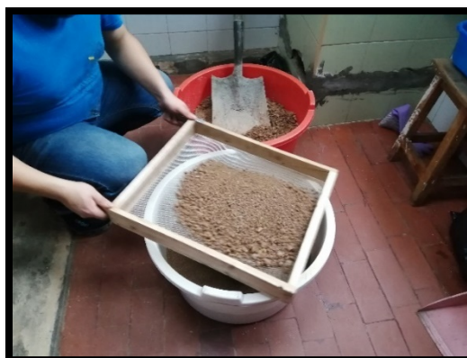
Figura 16. Tierra en proceso de cernida en la zaranda y siendo depositada en balde.
