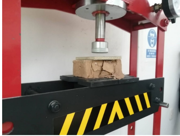
Figura 34. Muestra de tierra siendo probado en la prensa hidráulica.
