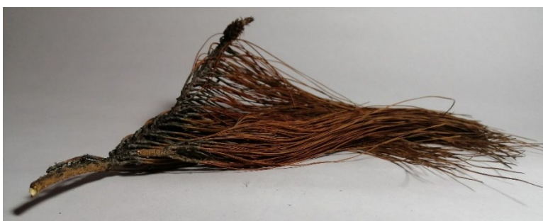
Figura 23. Rama de Pino con hojas secas para la mezcla en muestras de tapia pisada.
