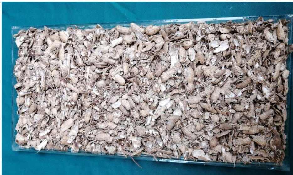
Figura 36. Molde de vidrio con residuos de cascara de mani y huevo de 24x20 cm y 1 cm de anchura
