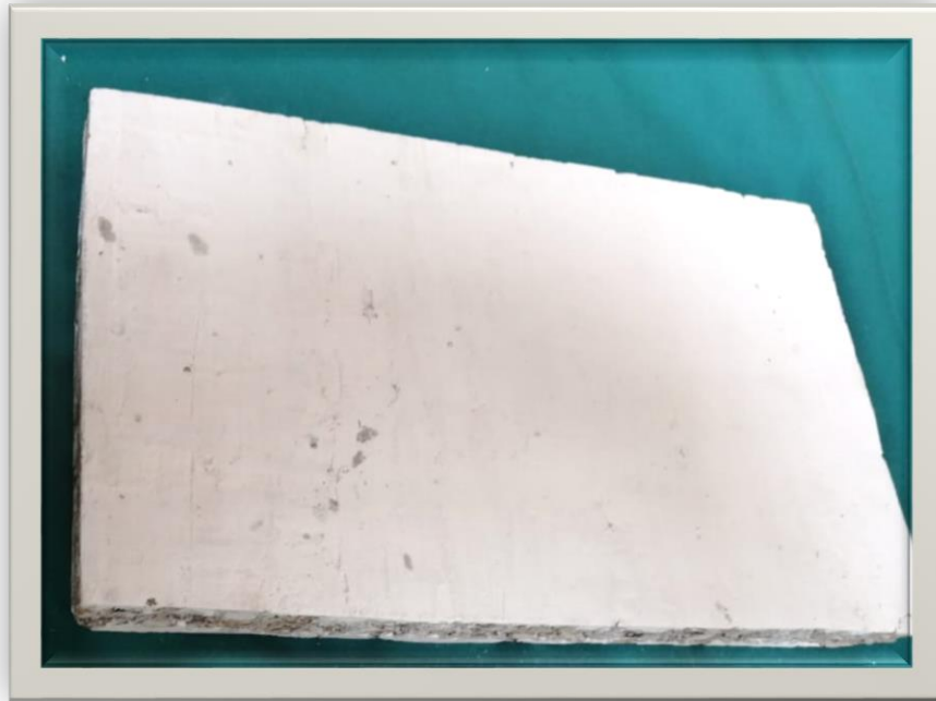
Figura 20. Molde 3. Mezcla de cascara de mani con yeso
