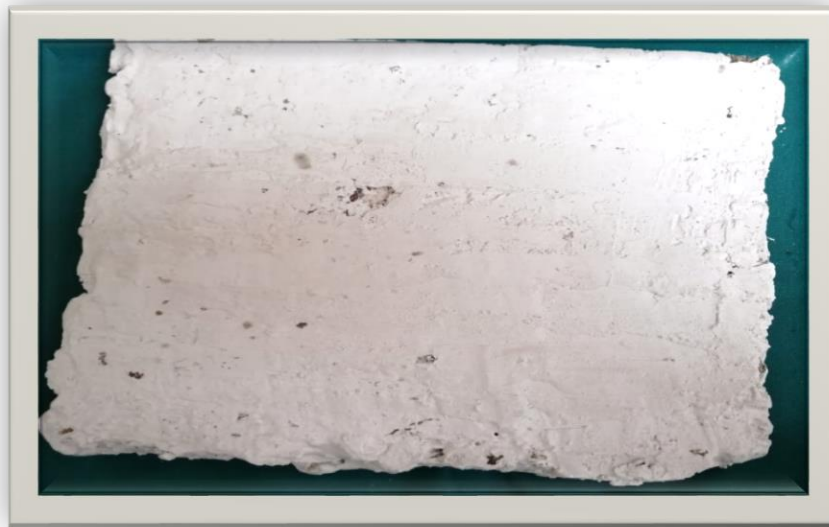
Figura 18. Molde 1. Mezcla de cascara de mani con resina y yeso
