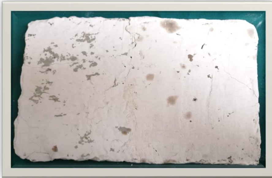
Figura 19. Molde 2. Mezcla de cascara de mani con yeso y estuco
