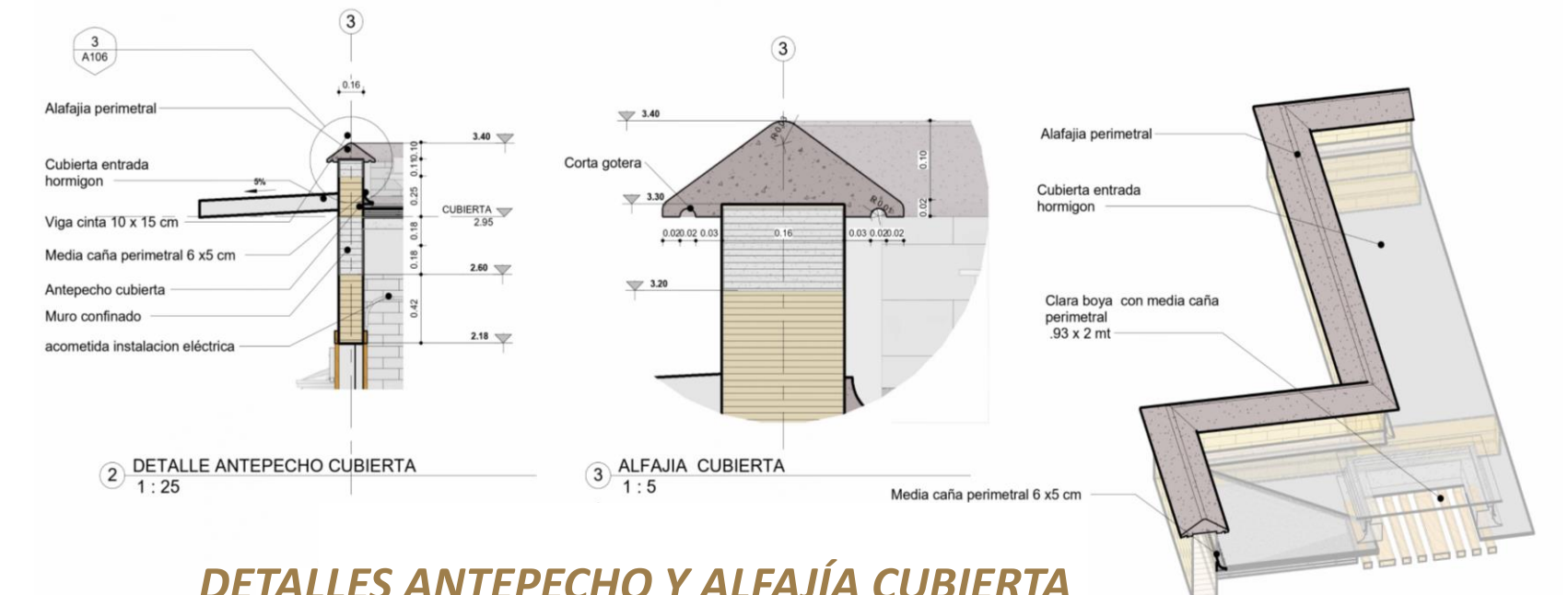
DETALLES ANTEPECHO Y ALFAJÍA CUBIERTA
