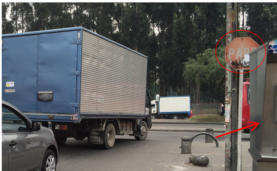
Imagen 18. Obstrucción de visibilidad de señales. Av. Boyacá y calle 7C bis
