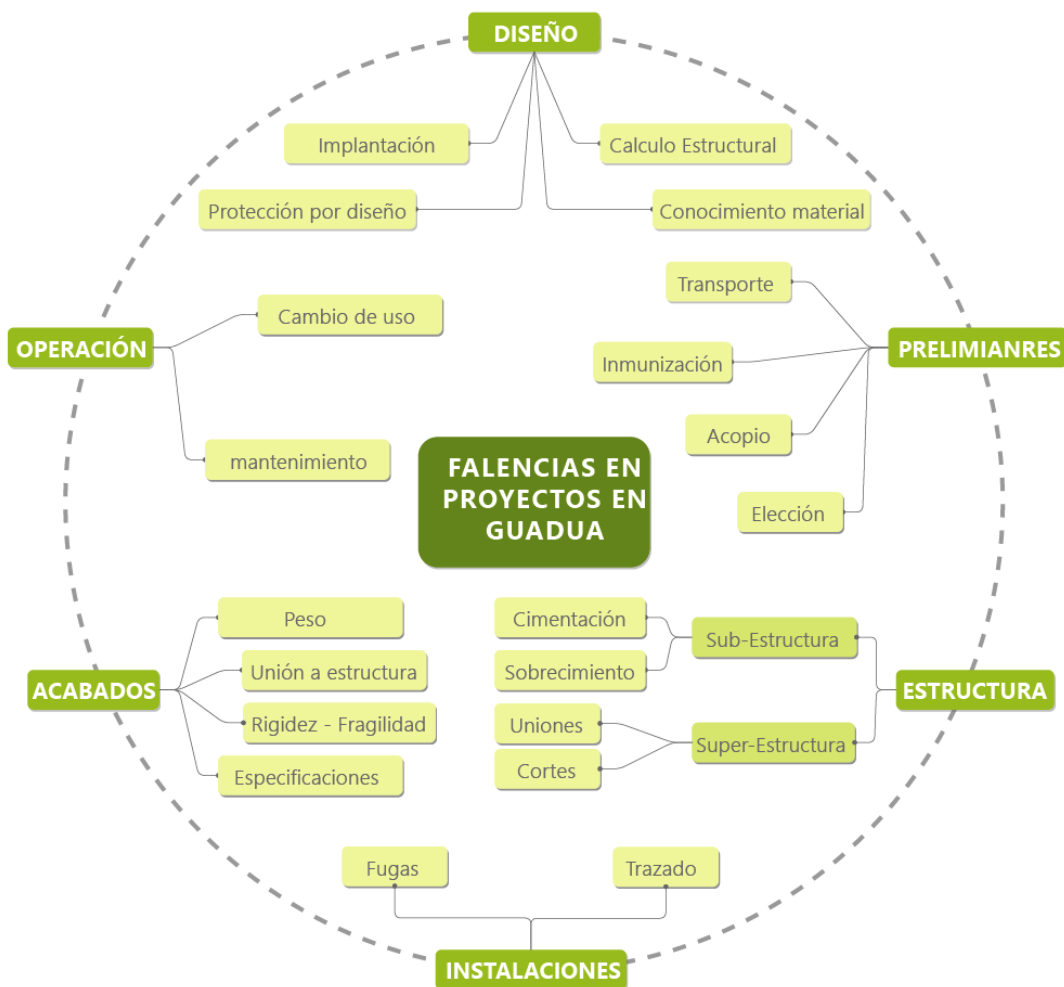
Figura 5 Falencias constructivas en el ciclo de vida de proyectos en guadua
