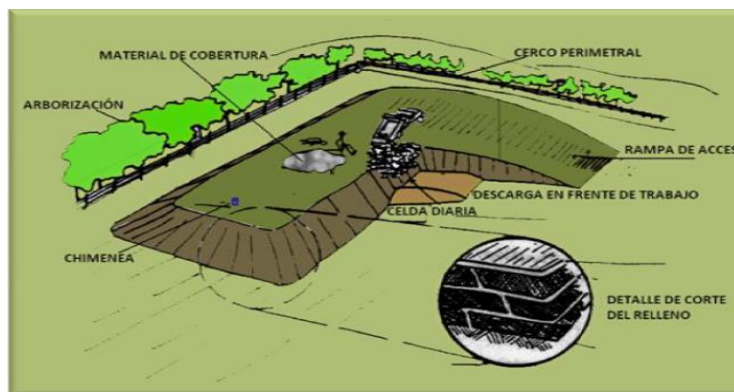
Imagen 6 Relleno sanitario manual
