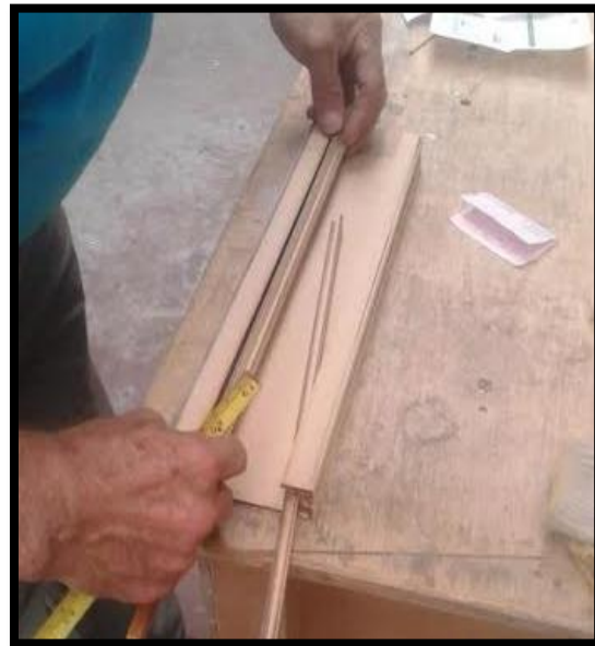
Imagen Número Cuatro: Elaboración Molde en MDF.
