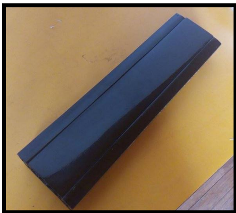
Imagen Número Diecisiete: Acabados Finales Del Prototipo en Resina Epoxica.
