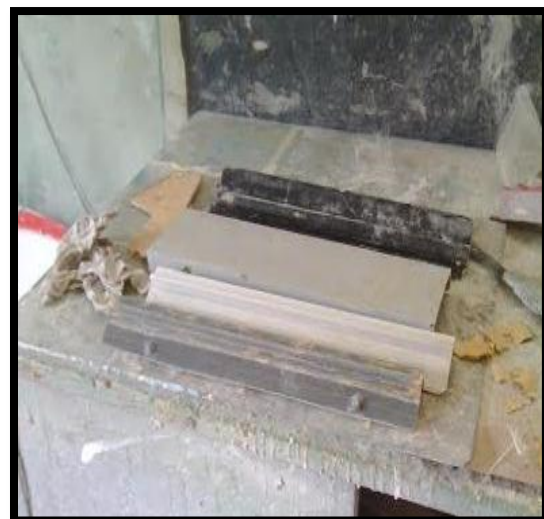
Imagen Número Diez: Aplicación Cera Sobre el molde en Resina Epoxica.
