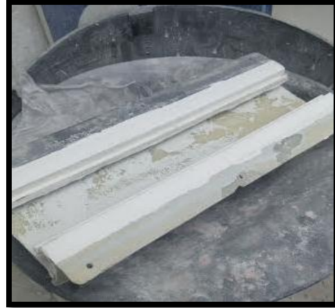
Imagen Número Dieciséis: Desmolde Del Prototipo en Resina Epoxica.
