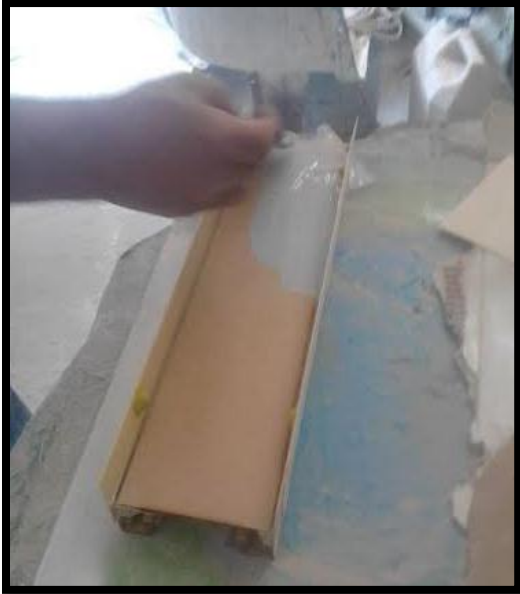
Imagen Número Cinco: Aplicación Desmoldante sobre elemento en MDF.
