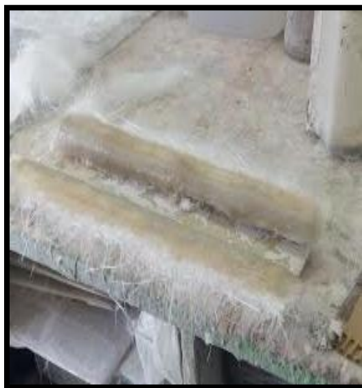
Imagen Número Catorce: Aplicación de La fibra de vidrio sobre el molde..
