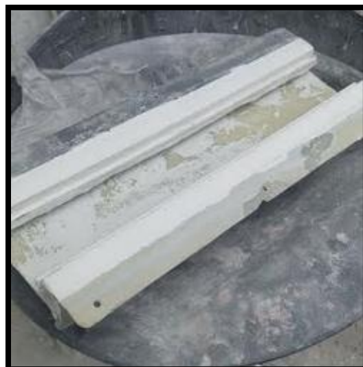
Imagen Número Doce: Preparación del Molde para aplicación de fibra de vidrio
