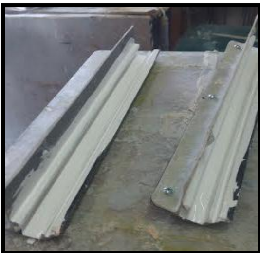
Imagen Número Nueve: Aplicación Cera Sobre el molde en Resina Epoxica.
