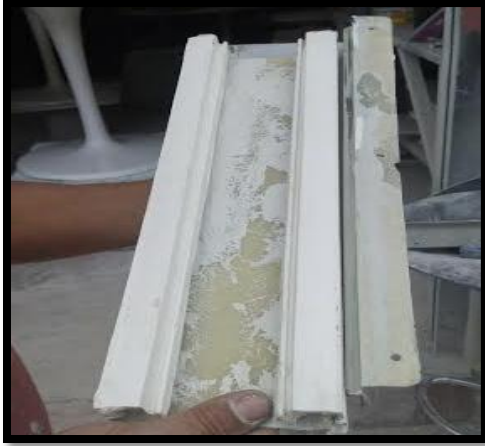
Imagen Número Quince: Desmolde Del Prototipo en Resina Epoxica.
