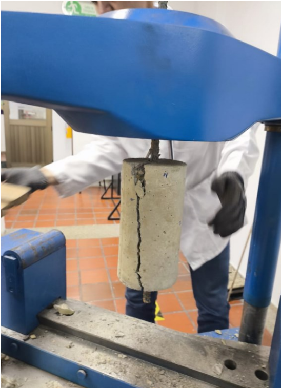
Figura 6 Ensayo de pull out en barras nuevas y usadas
