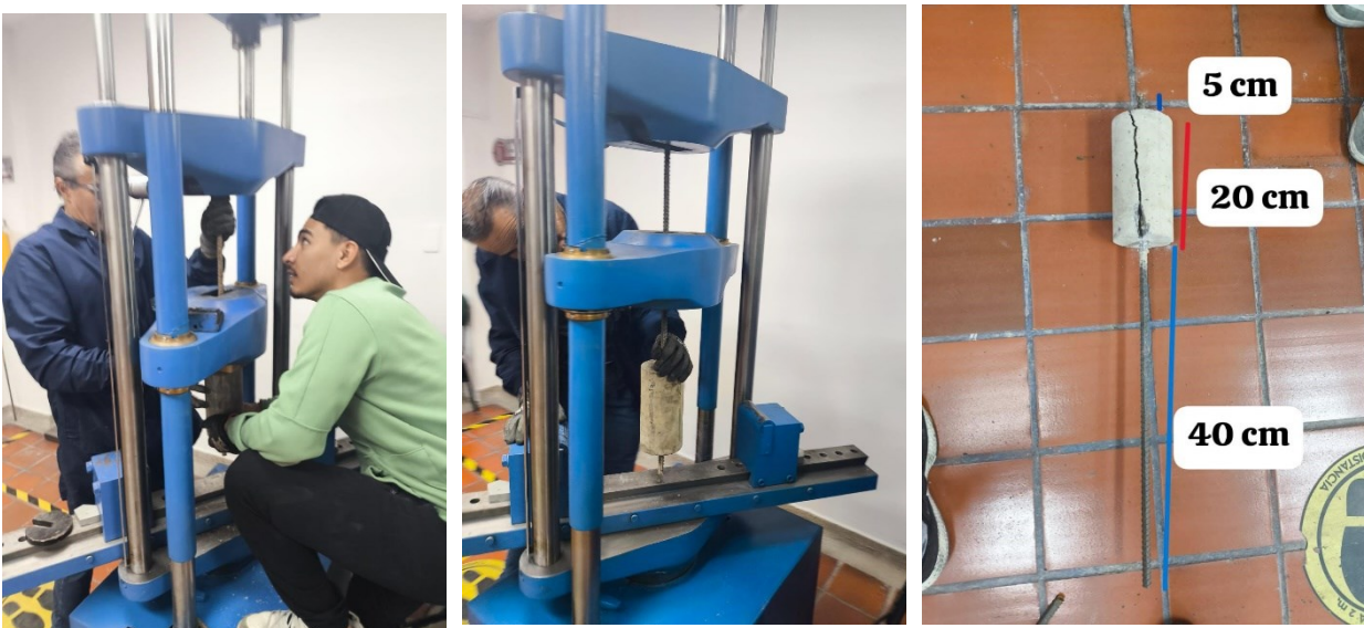
Figura 5 Ejecución del ensayo de Pull out
