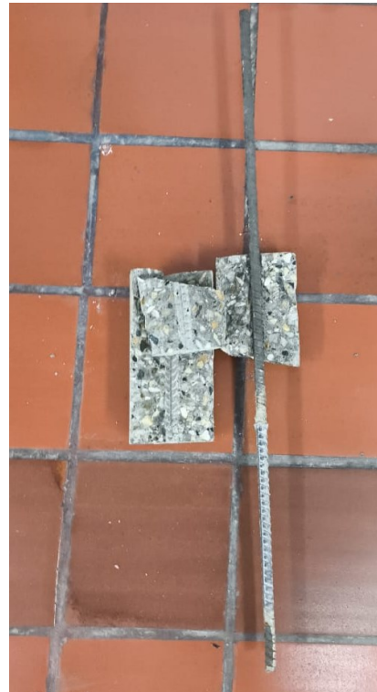
Figura 6 Ensayo de pull out en barras nuevas y usadas
