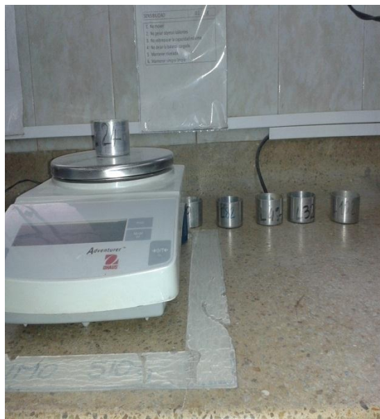
Ilustración 37. Determinación de la humedad natural. Autoría propia
