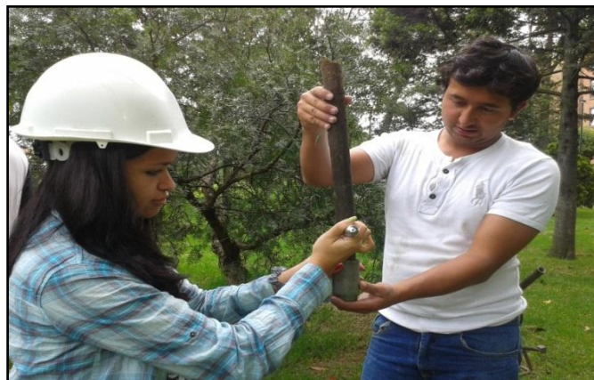
Ilustración 32. Prueba de resistencia con penetrometro. Autoría propia
