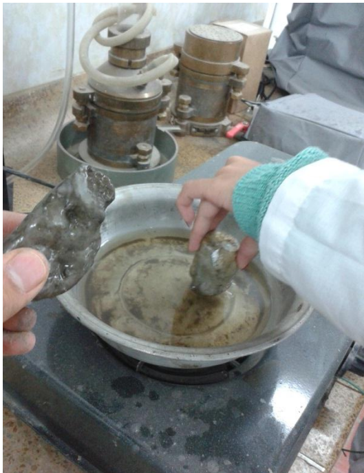
Ilustración 40 Proceso de parafinado de todas la muestras. Autoría Propia
