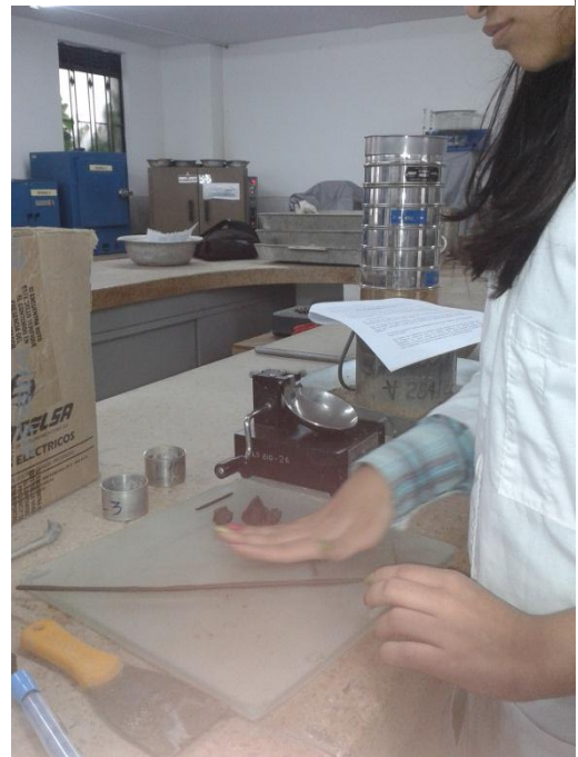
Ilustración 35. Determinación Límite Líquido. Autoría propia
