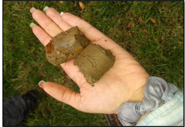
Ilustración 29. Condición de resequead de la primera muestra extraída en la zona de estudio.
