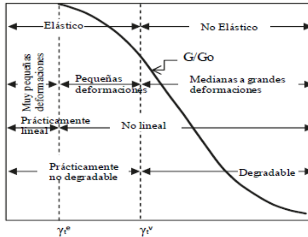
Ilustración 7 Curvas de degradación de modulo.
