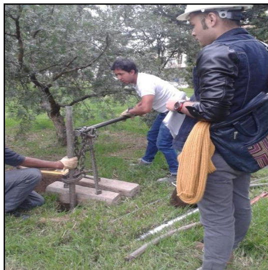
Ilustración 30. Recuperación muestreador de cuchara partida.
