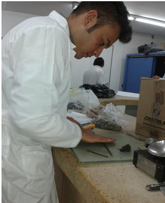
Ilustración 36. Determinación Límite Líquido. Autoría propia
