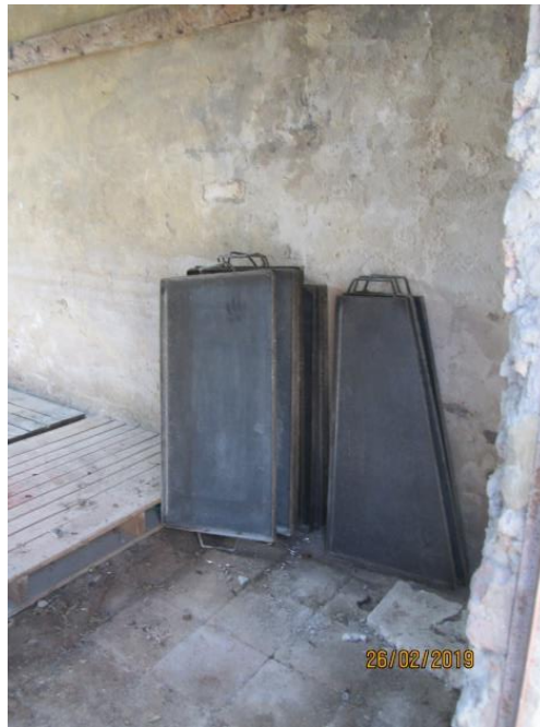
Figura 34. Formaletas 2-8 y 2-4-8 almacenadas y limpias Elaboración propia.
