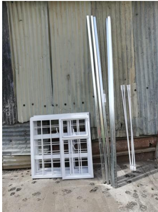
Figura 51. Componentes de vivienda, ventanas, perfiles y riostras Fuente: Elaboración propia.
