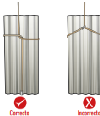
Figura 4. Manera correcta de izar una teja de Fibrocemento Recuperado de: https://bit.ly/2GXyxxwI
