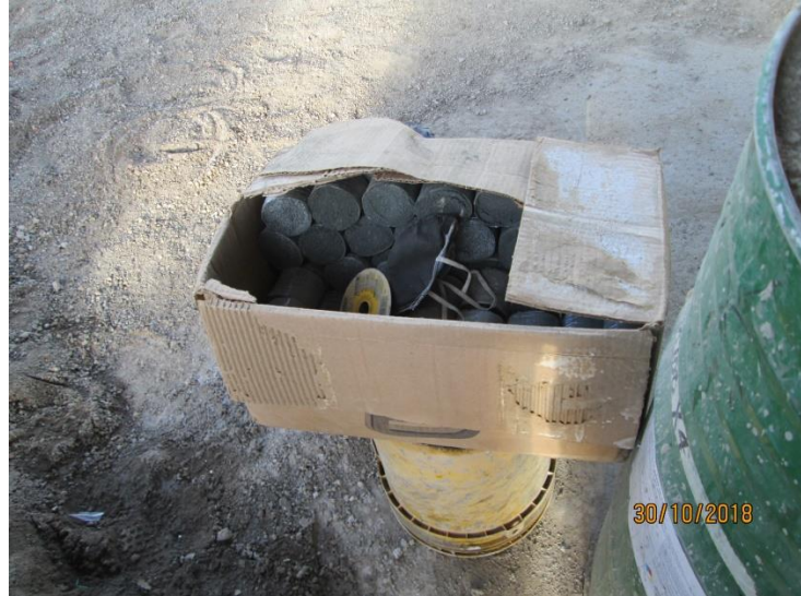
Figura 24. Fibra sintética Abacol. Almacenamiento de la fibra. Elaboración propia.
