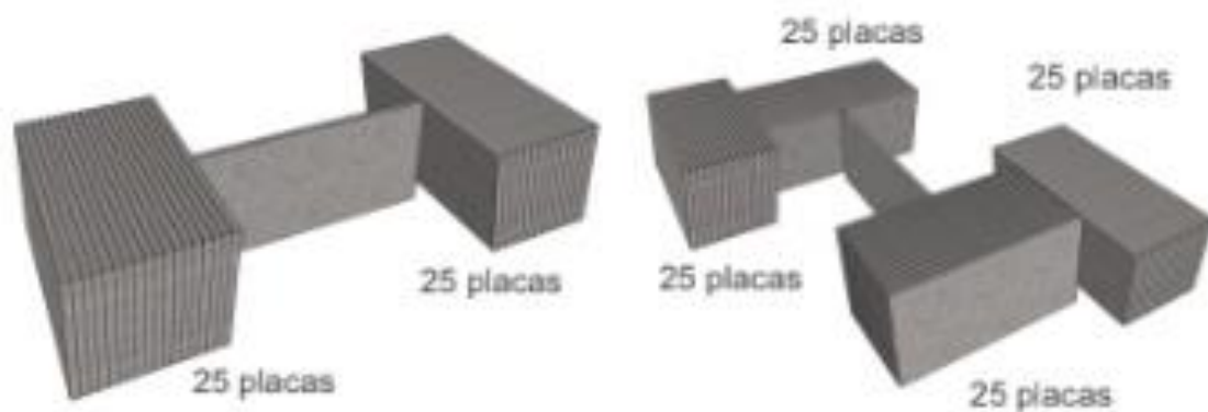
Figura 46. Acomodación de placas en forma de "I". Fuente: Adecuación de terrenos-Fundación Catalina Muñoz.
