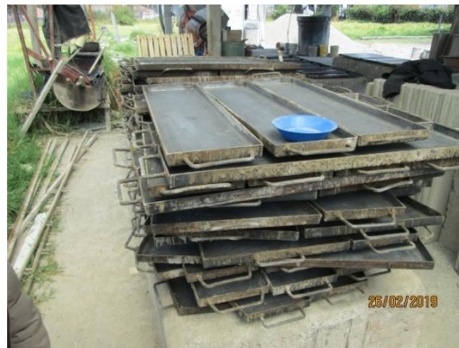
Figura 32. Apilamiento de Formaleta 2-8 limpias. Elaboración propia.
