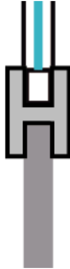
Figura 19. Perfil H. Recibe dos elementos. Elaboración propia.
