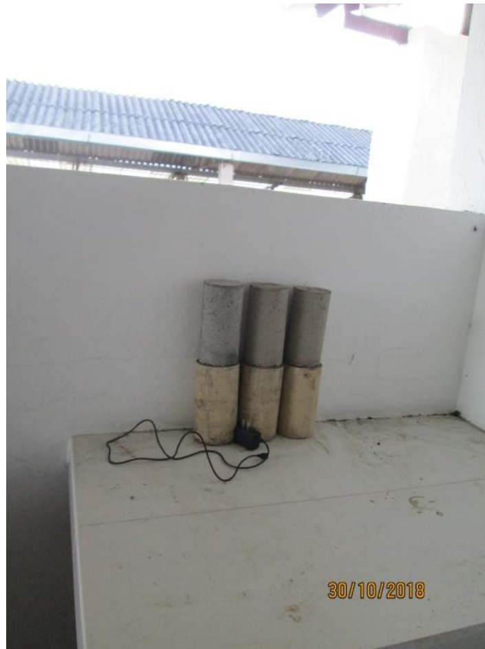
Figura 45. Testigos listos para ser enviados al laboratorio de Ing. De la Universidad Nacional de Colombia
