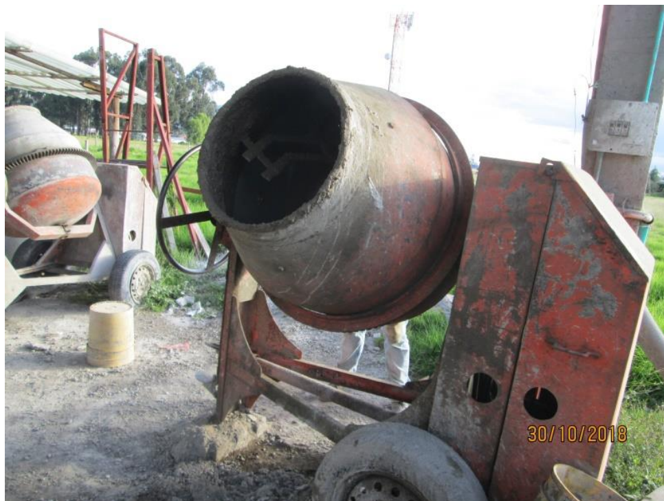
Figura 29. Trompo metálico. Se usa para preparar la mezcla. Elaboración propia.
