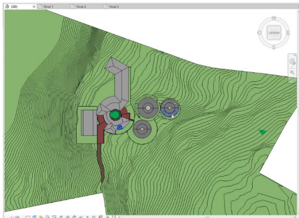
Figura 41. Importación de curvas de nivel en Revit
