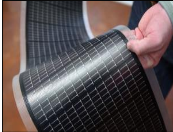
Figura 8. Panel solar de capa fina.
