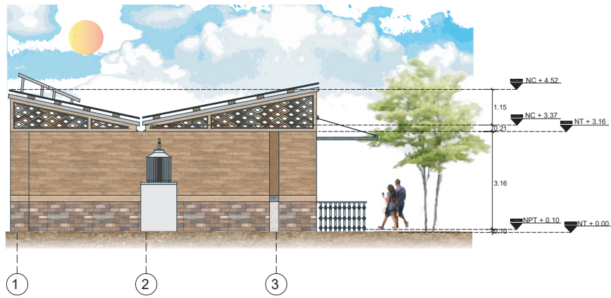
F4 FACHADA LATERAL TIPOLOGÍA E TE ESC. 1:50
