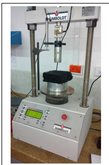
Ilustración 22: Colocación de la muestra en la máquina masterloader: (Autores).
