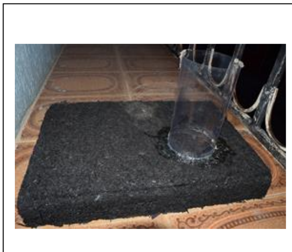
Ilustración 28: loseta de muestra con la adecuación de tubo transparente para el ensayo de absorción.
