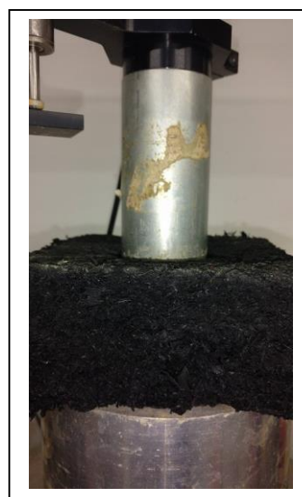
Ilustración 21: Proceso de punzonamiento en la muestra: (Autores).
