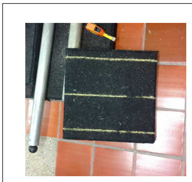
Ilustración 24: marcación para el ensayo de flexo tracción en loseta de muestra.
