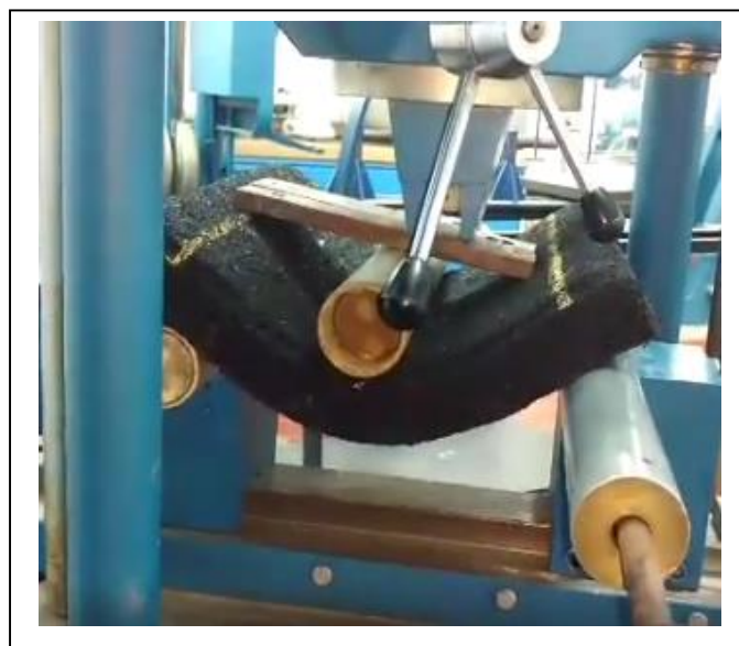
Ilustración 26: ensayo de flexotracción en losetas de caucho.
