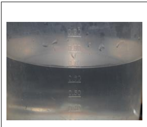
Ilustración 27: medición de niveles de agua para prueba de absorción en las losetas.
