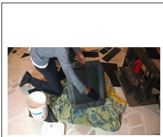
Ilustración 9: Proceso de desencofraste con aceite quemado
