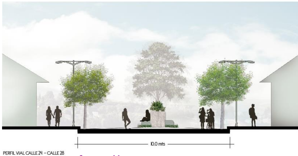
Imagen 11. Perfil vial, sendero peatonal para conectar con Universidad de Cundinamarca. Fuente: Valdés, Rojas, 2018
